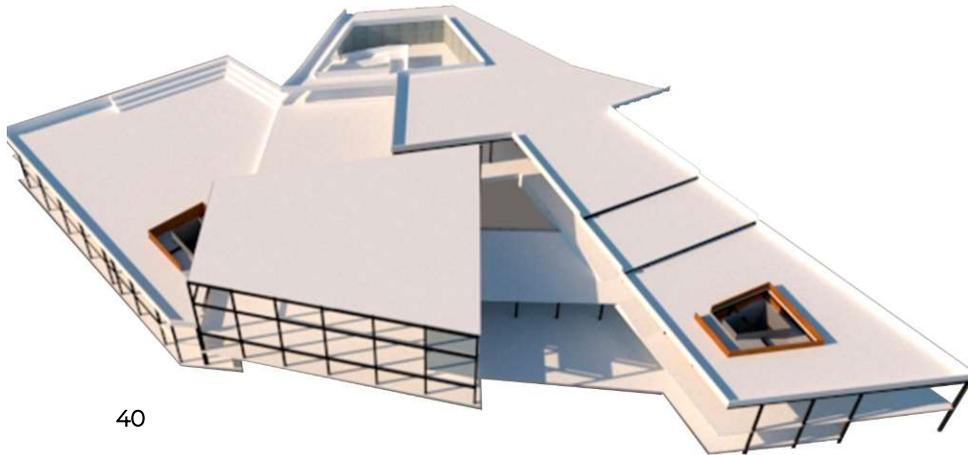
El sistema que conformará la estructura del edificio será combinado, a base de zapatas corridas, muros de contención, estructura de acero con vigas IPR y columnas PTR, cubiertas de concreto y losa cero. La construcción abarca desde el nivel 0.00 PT hasta el nivel +21.00NPT a base de planchas de concreto, y cubiertas que se convierten en terrazas.
