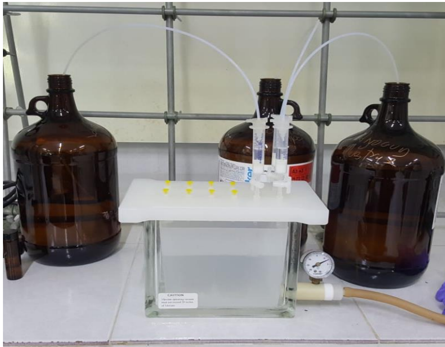
Fig 8. Enriquecimiento en SPE, con cartuchos Strata C18-U Phenomenex de 8 L de agua de cada pozo muestreado.
