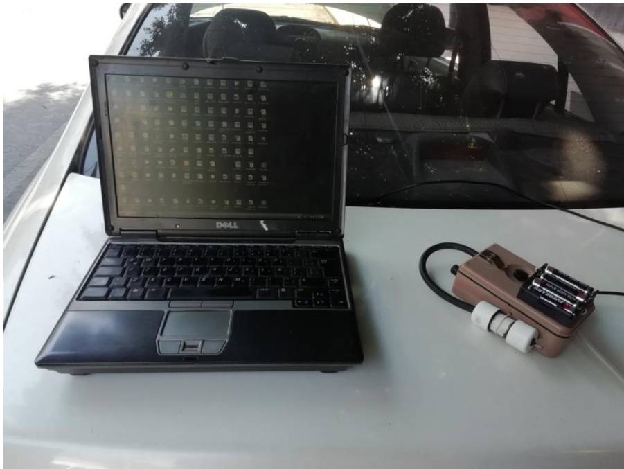
Figura 4.3. Muestra el arreglo experimental mientras se realiza un análisis de gas de tipo estático a velocidad de ralentí en un vehículo Renault Scala modelo 2011
