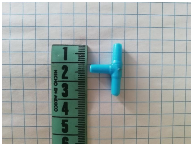
Figura 2.6, Que muestra las características básicas y dimensiones de la TEE empleada
