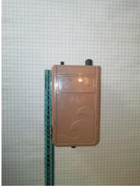
Figura 2.10. Vista frontal del compresor y sus dimensiones aproximadas
