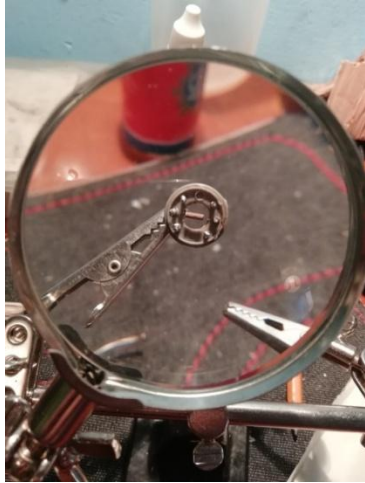
Figura 2.24. Donde se aprecia la base Inferior del señor MQ-3 barrenada en su carcasa inferior
