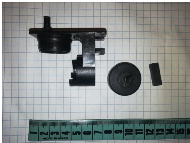
Figura 2.13. Que muestra el desensamblado del mini compresor empleado en el proyecto
