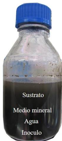
Figura 4.3 Esquema general de la preparación de los contenedores para las pruebas de potencial de metano.
