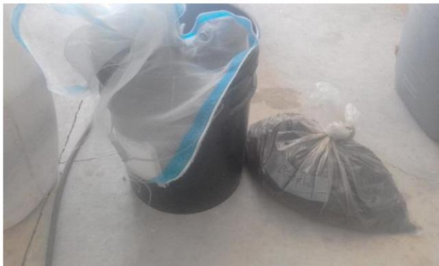
Figura 4.1 Extracción de lixiviados de termohidrólisis en agua con malla de 0.5 mm por 24 h.
