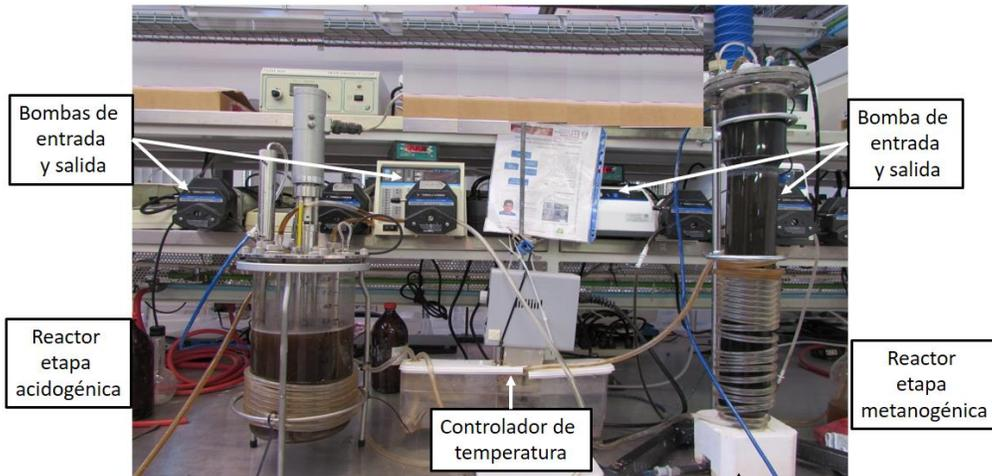
**Figura 5.2 Sistema en dos etapas escala laboratorio.**
