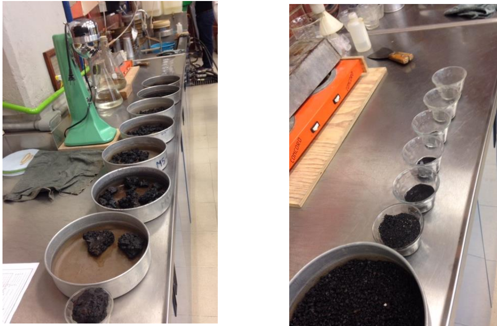
Figura 3.3 Tamizado de E1 para realizar curva granulométrica
