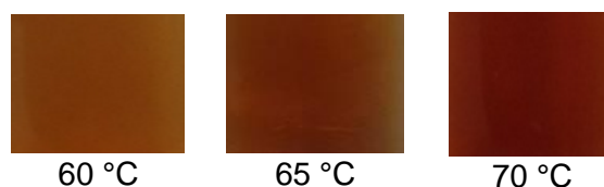
Figura 26 Serie de fotografías correspondientes a soluciones coloridas de nanopartículas de plata (efecto de la temperatura)
