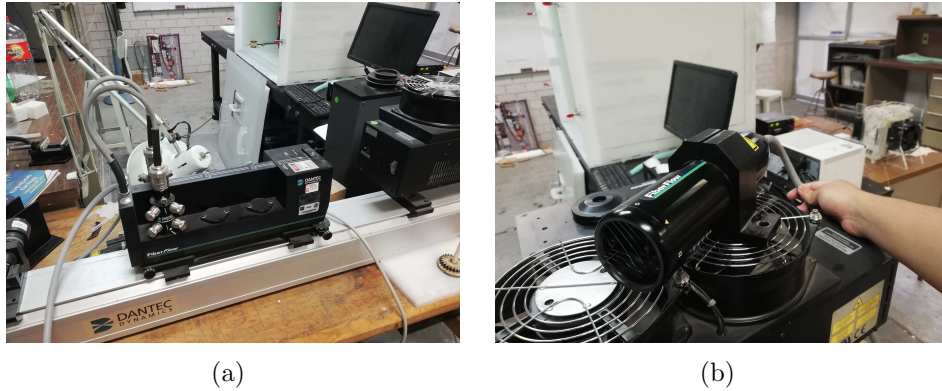
Figura 3.8: Fotografía del sistema LDA utilizado se muestra el (a) Emisor 60X41, un manipulador de fibra 60X24 y (b) la sonda 60X60.
