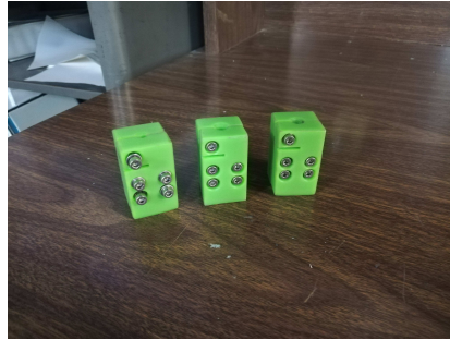
Figura 3.4: Soportes de plástico manufacturados para colocar de manera correcta los instrumentos de medición, se usaron tuercas y tornillos para lograr el ajuste deseado.
