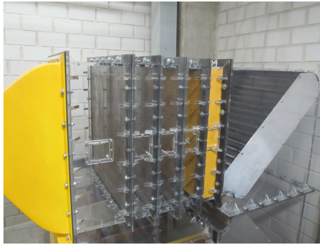
Figura 3.3: Zona de asentamiento de flujo, se puede observar las ventanas usadas para instrumentar esta zona.
