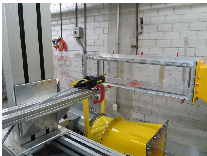
Figura 3.18: Láser montado en el sistema de posicionamiento listo para tomar mediciones.
