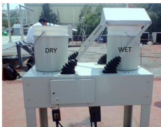
Figura 4.2. Sistema de muestreo de depósito atmosférico, a la derecha se ubica el colector para depósito húmedo y a la izquierda el de depósito seco
