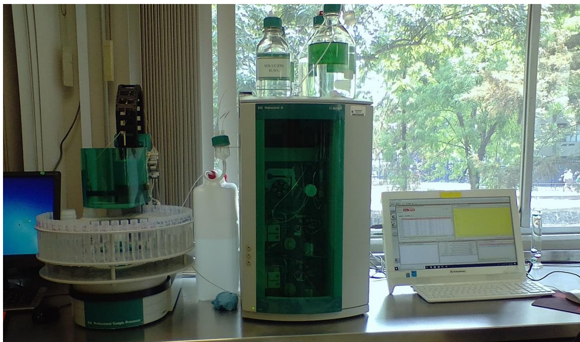
Figura 4.8. Cromatógrafo de líquidos empleado para el análisis de iones de las muestras de depósito atmosférico húmedo
