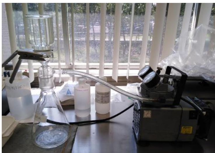
Figura 4.4. Sistema de filtración de muestras de depósito húmedo.
