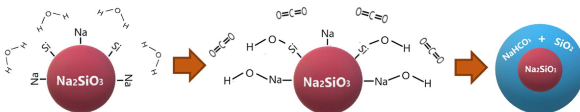
Figura 1.1. Representación esquemática del mecanismo de reacción de captura de \text{CO}_2 en los cerámicos alcalinos en presencia de vapor de agua, utilizando el caso del \text{Na}_2\text{SiO}_3 .
