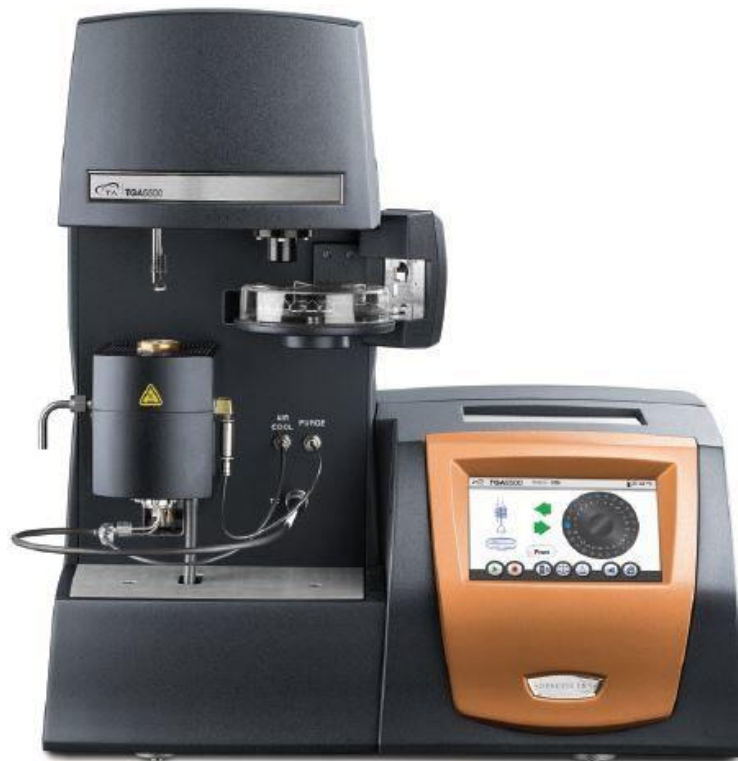
Figura 18 analizador termogravimétrico TGA 5500
