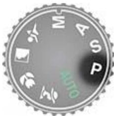
En el modo de exposición Programa, la cámara selecciona automáticamente la apertura del diafragma y la velocidad de obturación en función del valor de exposición proporcionado por el exposímetro.
