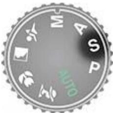
En el modo de prioridad de velocidad de obturación, el fotógrafo selecciona la velocidad de obturación y la cámara establece automáticamente la apertura del diafragma, según el valor de exposición proporcionado por el exposímetro.
