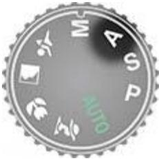
En el modo de prioridad de apertura, el fotógrafo selecciona la apertura del diafragma y la cámara establece automáticamente la velocidad de obturación, según el valor de exposición proporcionado por el exposímetro.
