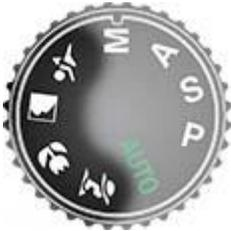
Los modos de escena son modos de exposición programados en los que la cámara ajusta automáticamente la apertura del diafragma y la velocidad de obturación teniendo en cuenta (además del valor de exposición proporcionado por el exposímetro de la cámara) el tipo de escena seleccionado.
