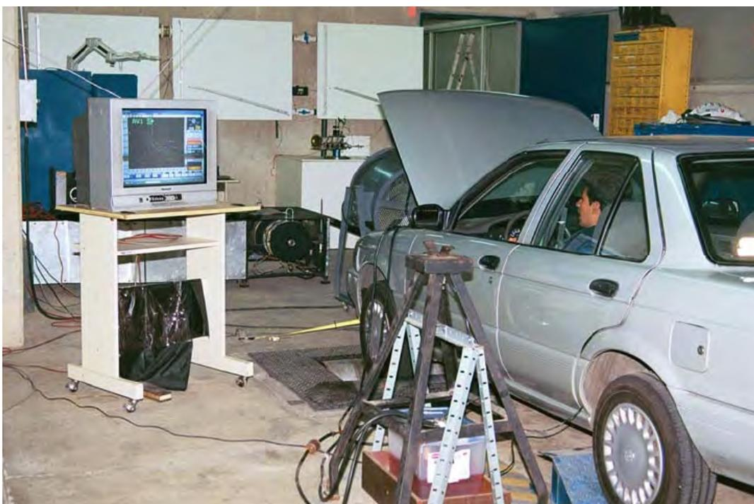
Figura 2.6: Análisis de emisiones contaminantes de un automóvil en dinamómetro.
