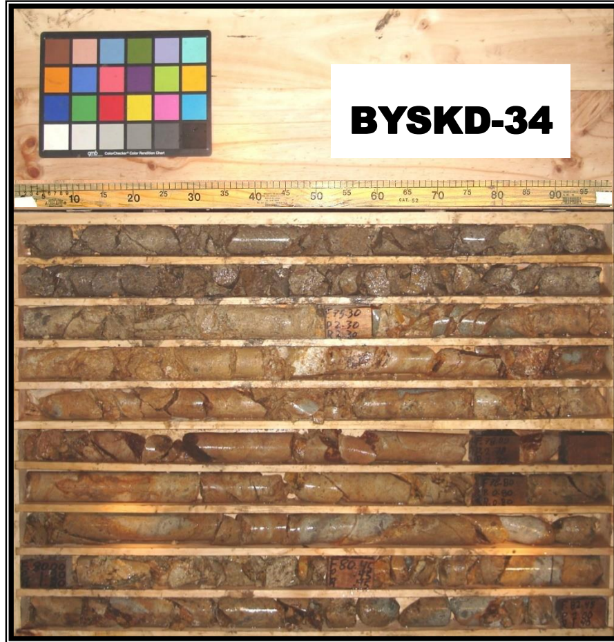
Figura 18. Muestra del núcleo seco de 73,20 m a 82,45 m (CFE, 2007).
