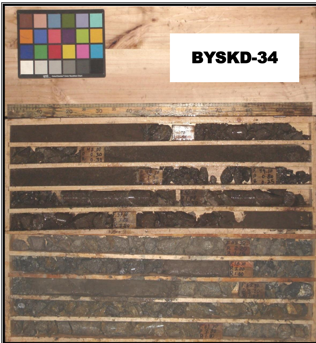
Figura 17. Muestra del núcleo seco de 45,20 m a 63,50 m (CFE, 2007).
