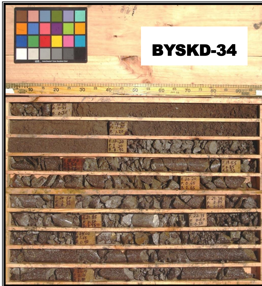
Figura 16. Muestra del núcleo seco del tramo 14,00 a 27,30 m (CFE, 2007).
