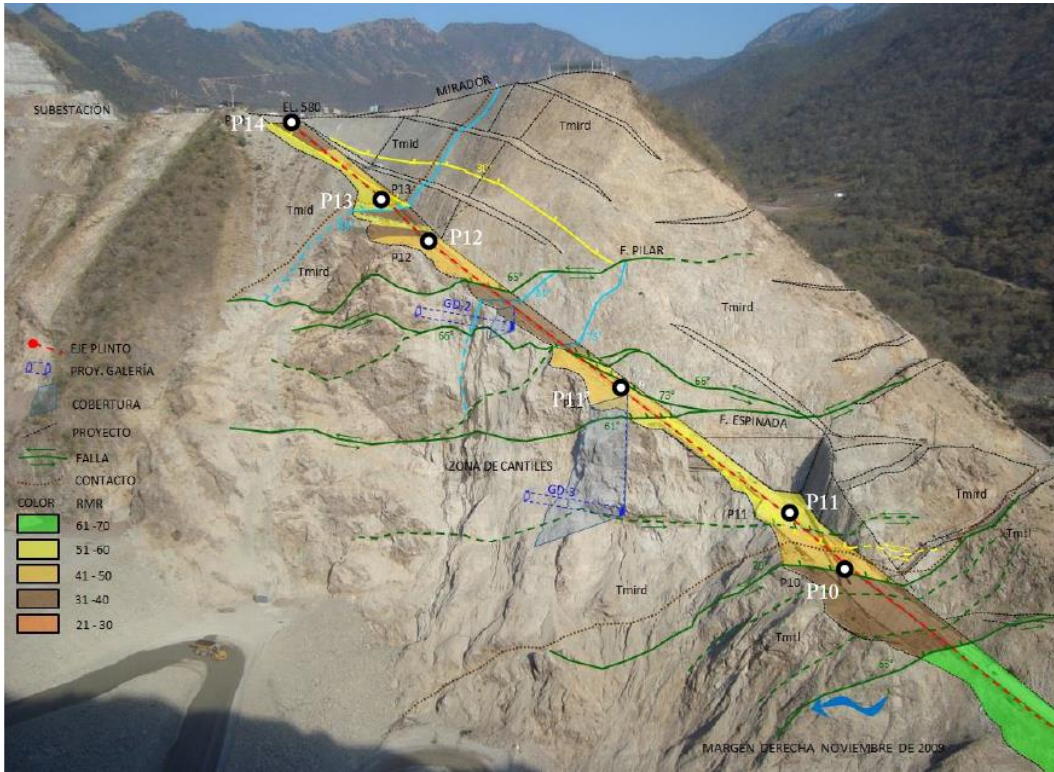
Figura 37. Vista de MD, trazo del plinto y calidad RMR del macizo rocoso (CFE, 2014).
