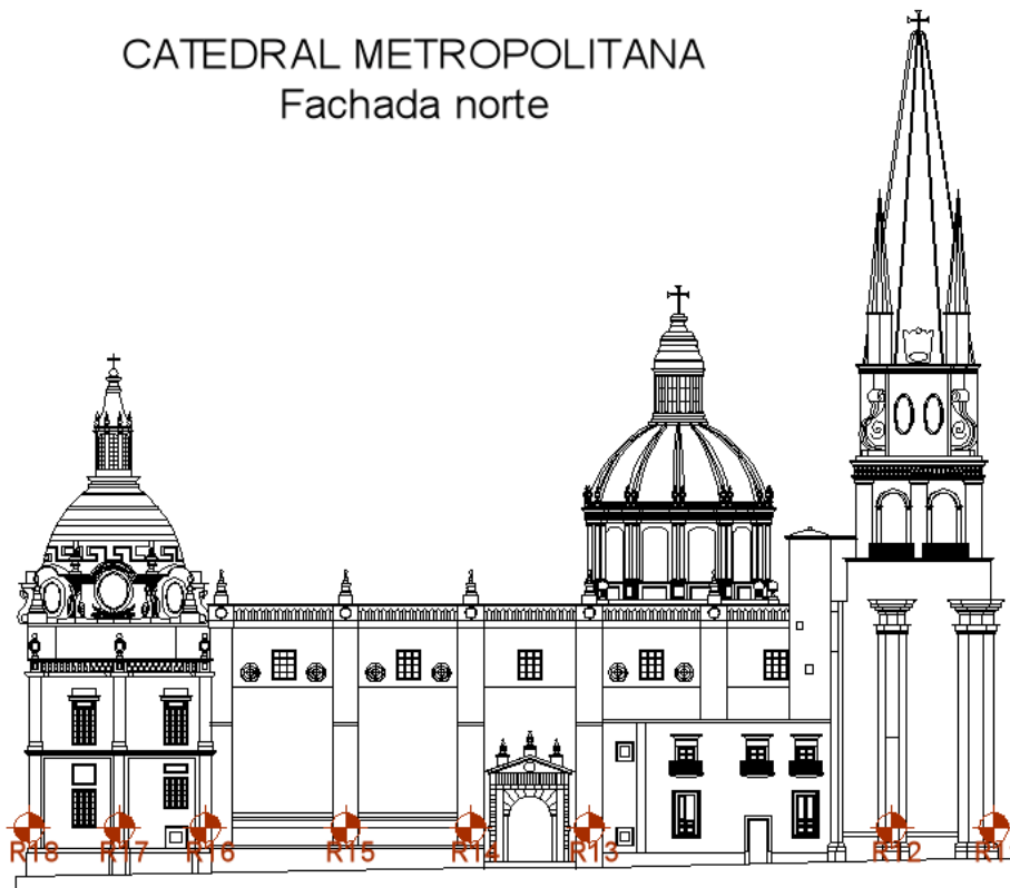
Figura 28. Localización de clavos de nivelación. Catedral Metropolitana, fachada norte.
