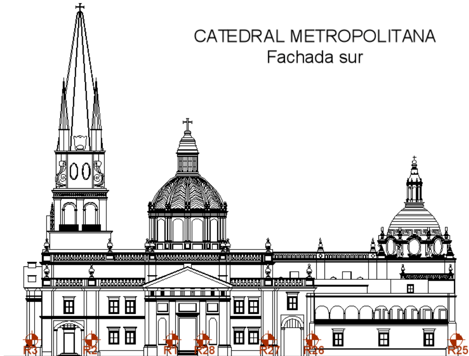
Figura 26. Localización de clavos de nivelación. Catedral Metropolitana (Sagrario), fachada sur.
