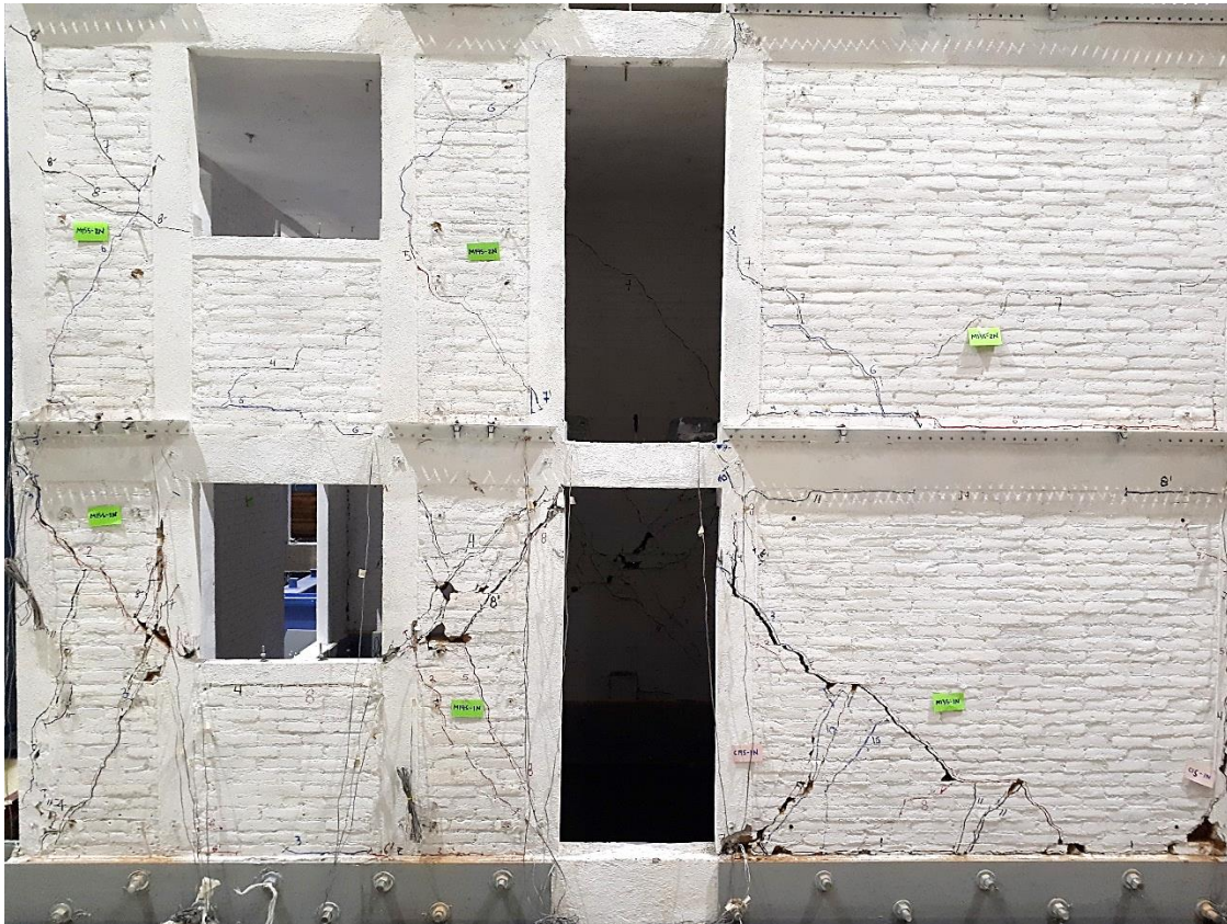
Fig. 3.54. Estado final de daño en primer y segundo nivel de fachada sur (eje C)
