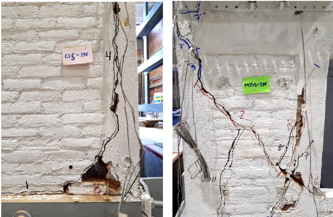
Fig. 3.54. Estado final de daño en primer y segundo nivel de fachada sur (eje C)
