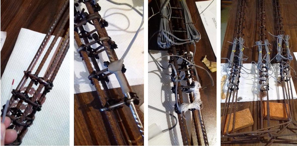
Figura 2.31. Deformímetros eléctricos en acero de refuerzo de castillos
