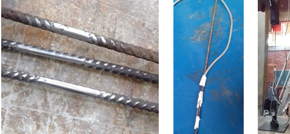
Figura 2.24. Ensaye a tensión en barras de acero de refuerzo instrumentadas con deformímetros eléctricos
