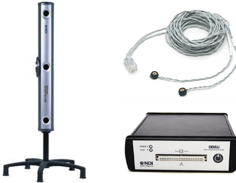
Figura 2.16. Sistema “Optotrak” utilizado en los ensayos de pilas y muretes
