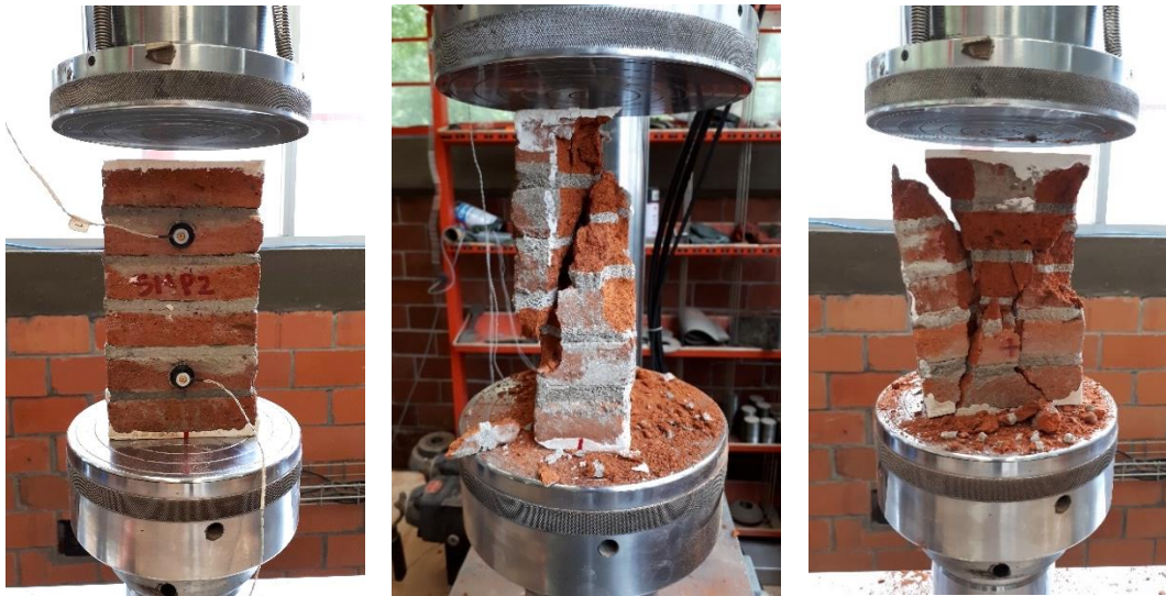
Figura 2.13. Ensayo a compresión de pilas de mampostería
