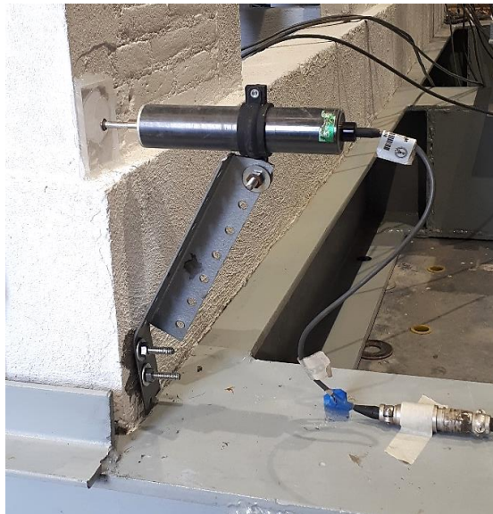
Figura 2.62. Transductores en ejes A y C en cimentación del modelo
