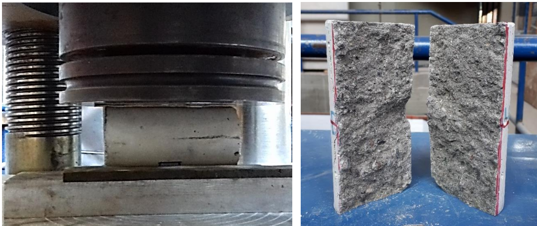
Figura 2.21. Ensaye a tensión (compresión diametral) en cilindros de concreto
