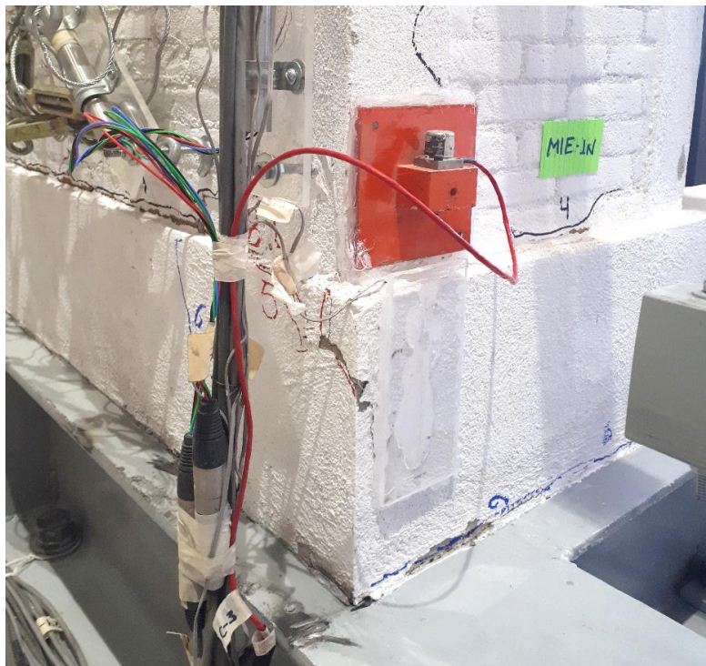
Fig. 3.61. Detalle de agrietamiento en dala de cimentación en esquina sureste (previo al refuerzo, durante la primera etapa de ensayos)
