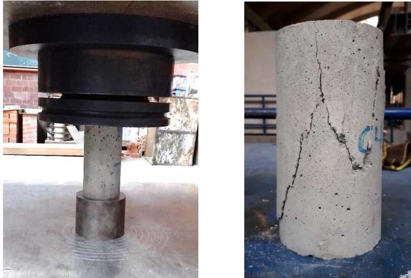
Figura 2.20. Ensaye a compresión axial en cilindros de concreto
