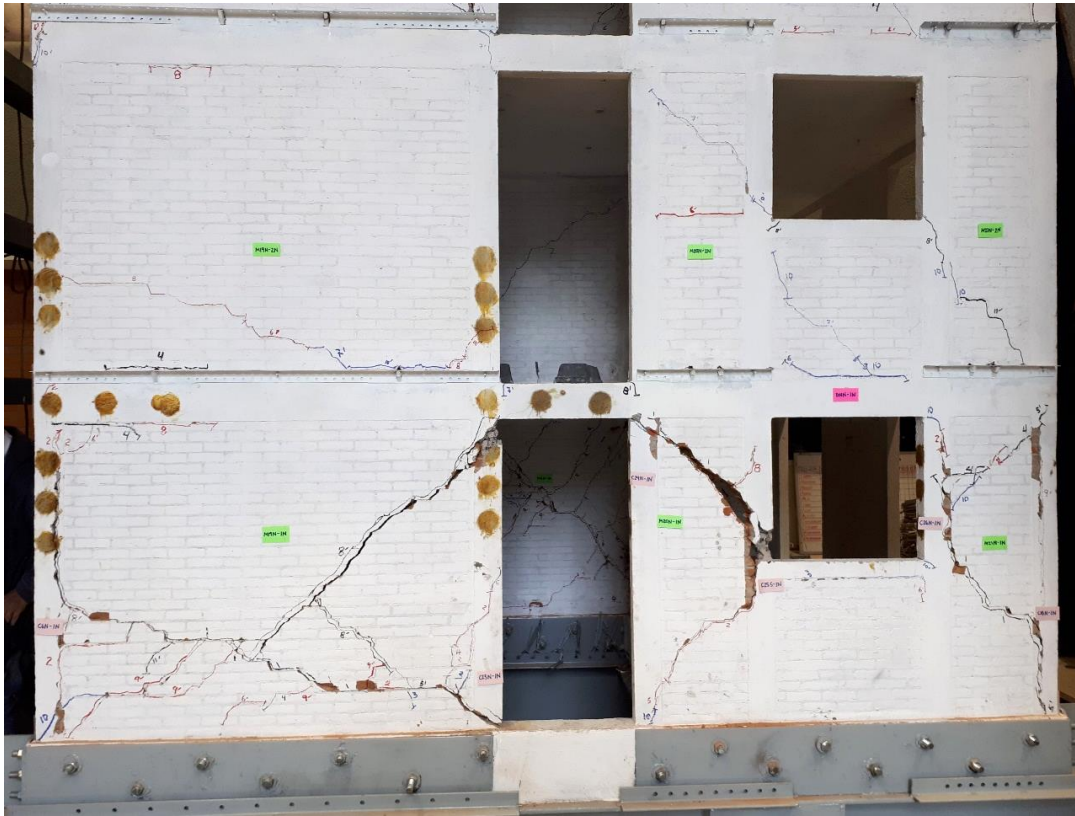
Fig. 3.51. Estado final de daño en primer y segundo nivel de fachada norte (eje A)
