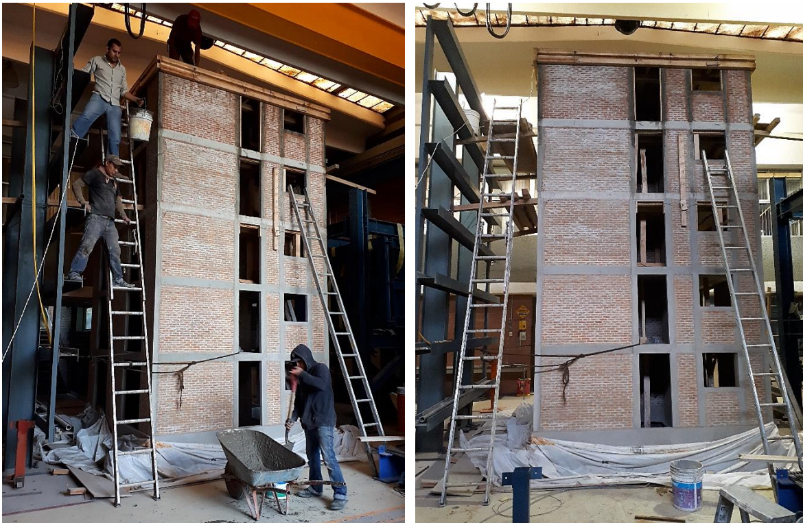
Figura 2.42. Colado de losa de concreto del quinto nivel
