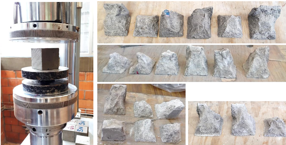
Figura 2.12. Ensaye a compresión de cubos de mortero
