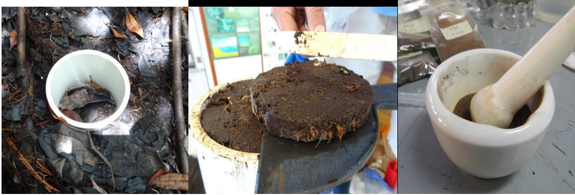
Figura 4. Muestreo y sub-muestreo de los núcleos sedimentarios extraídos en manglares de Puerto Morelos, Q. Roo y molienda de las muestras en mortero.
