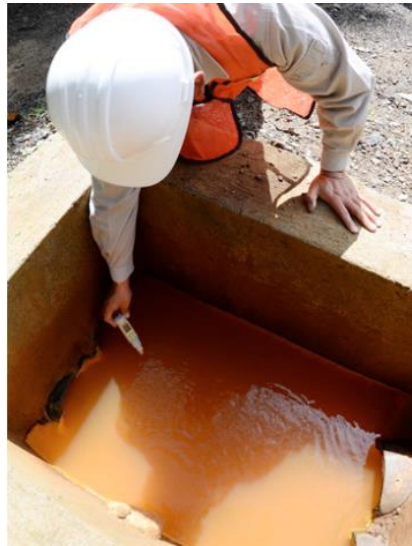
Figura 5 DAM proveniente del socavón 1412. Foto tomada de: (Romero, 2016)
