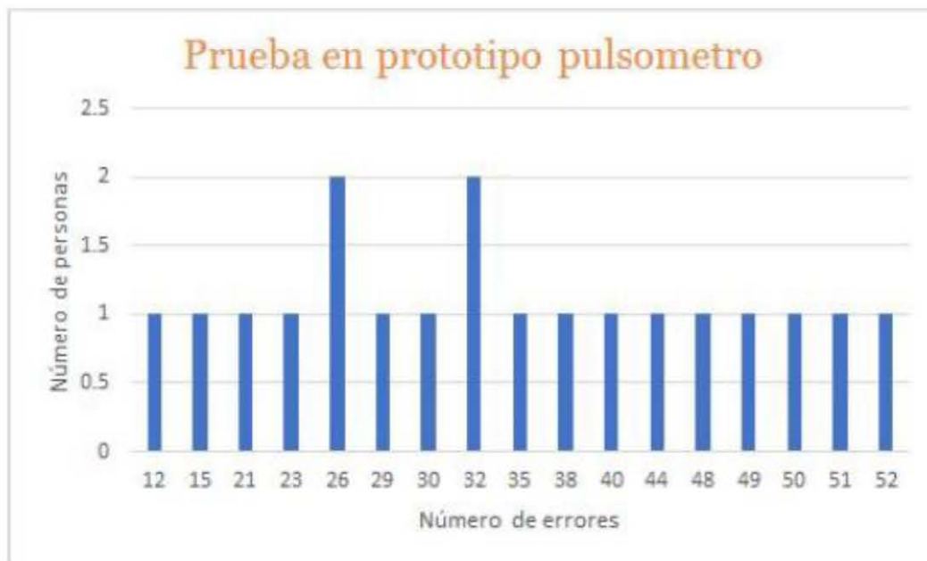
Figura 3.10. Gráfica correspondiente al número de errores de función crítica del pulsómetro
