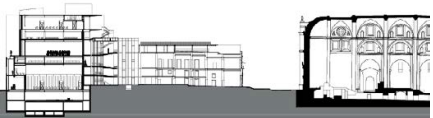
- Corte del sitio, donde se pueden ver las diferentes alturas, tanto de la terraza, como de la Catedral y el edificio contiguo del CCEMx, estas diferencias de nivel no permiten la circulación del aire en la terraza y si se incluye la cubierta de cristal, el efecto invernadero se presenta haciendo de este espacio un horno -
