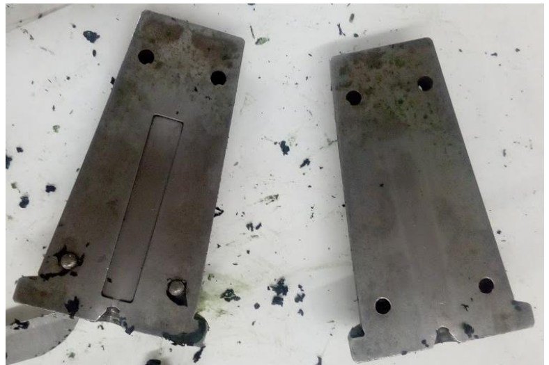
Figura 11. Molde rectangular de acero inoxidable con las medidas requeridas para los ensayos de deformación
