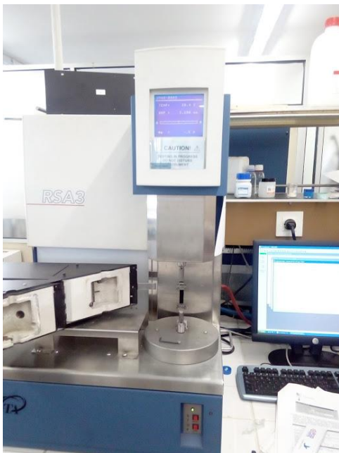
Figura 12. Los sensores usados para esta prueba son de tipo prensa y retienen el material a evaluar.
