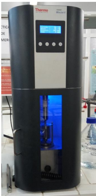
Figura 10. Al interior del equipo se coloca primero el molde seguido de la cámara de inyección, la cual recibe el impacto del pistón para la distribución del material en el molde.
