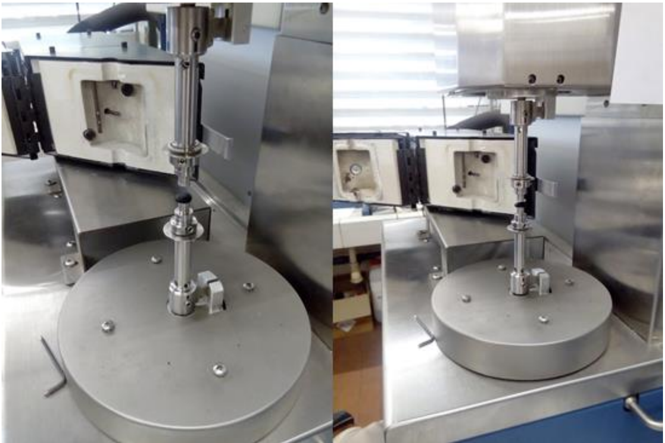
Figura 9. Los sensores utilizados para esta prueba tienen una superficie plana que al hacer contacto con la muestra le transmiten la energía necesaria para realizar el ensayo.
