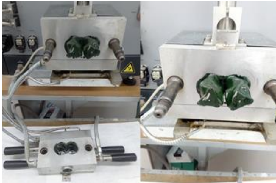
Figura 22. Mezclador al término del tiempo programado, entre los rodillos giratorios se encuentra la mezcla de la biomasa microalgal con el plastificante
