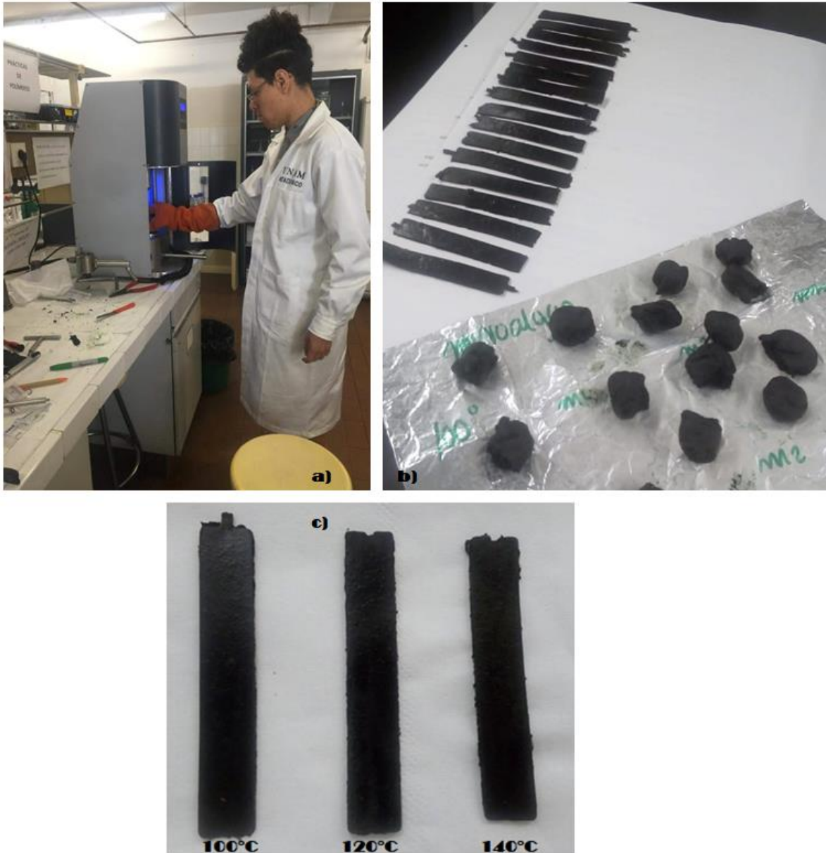
Figura 25. Probetas obtenidas del moldeo por inyección. A) Inyección de la masa en el equipo. B) Probetas obtenidas a partir de la biomasa microalgal. c) Probetas obtenidas a partir de diferentes temperaturas de moldeo
