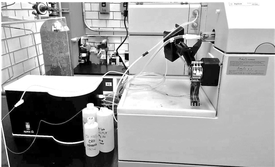
Figura 10. Acoplamiento de sistema Apex  $\Omega$  con ICP-MS.
