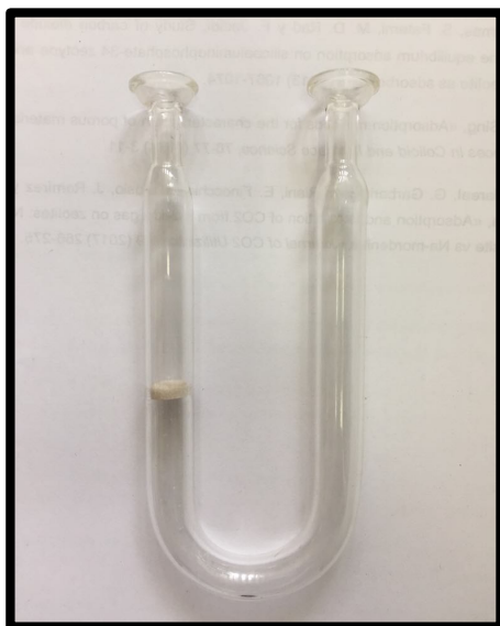
Figura 3.3.1. Reactor continuo de lecho fijo.
