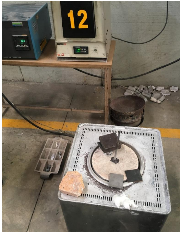
Figura 4.3. Horno utilizado para fundir los pequeños lingotes de aleación 355 y 359
