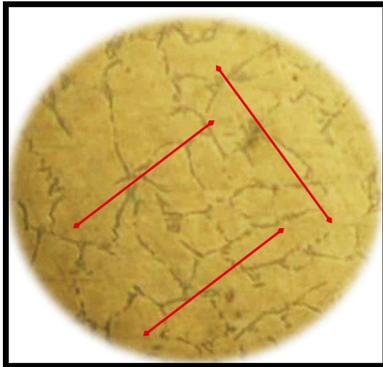
Figura 5.13 Al A357 Lingote Blanco sin Sr a 650x
