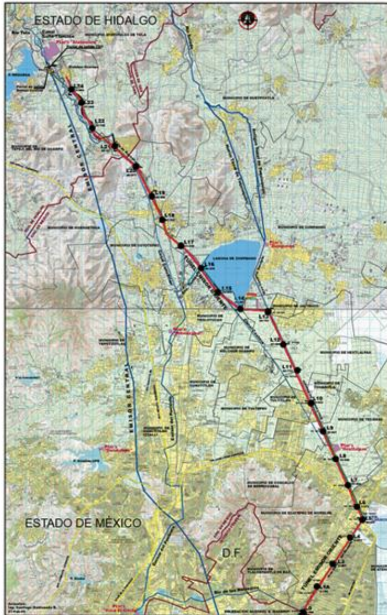
Imagen 17. Trazo del proyecto Túnel Emisor Oriente, se puede observar que el túnel pasa a un lado de la laguna de Zumpango.
