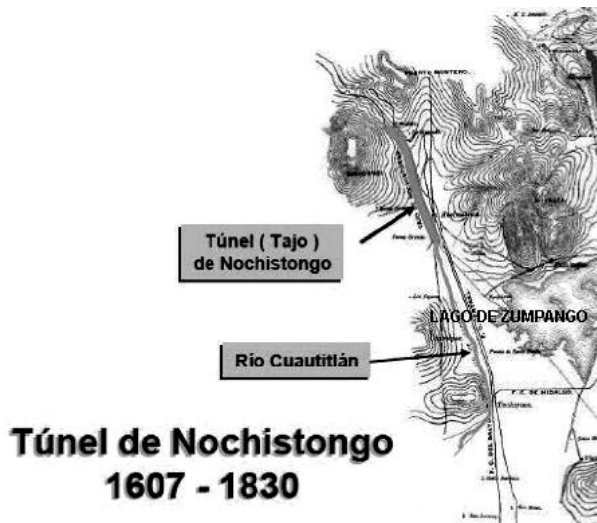
Imagen 7. Ubicación del túnel o tajo de Nochistongo con lo que se desvían las aguas del río Cuautitlán, evitando que lleguen a Zumpango.
