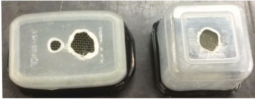
Figura 4.1 Vista superior de las celdas electroquímicas, el recipiente del lado izquierdo tiene un área de 28 cm 2 y el de la derecha es 25 cm 2 .
