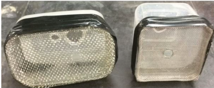
Figura 4.2 Vista inferior de las celdas electroquímicas, el recipiente del lado izquierdo tiene un área de malla de 28 cm 2 y el de la derecha 25 cm 2 .
