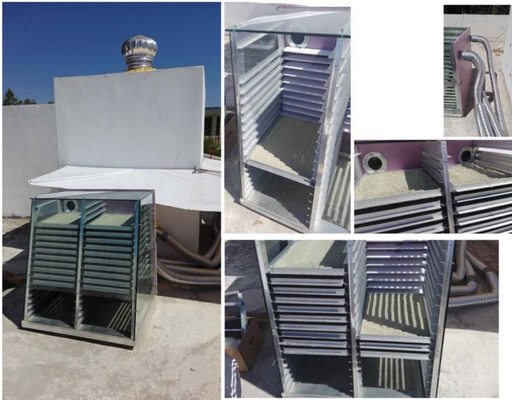
Fig. 108. Construcción proceso experimental, bandejas dentro del módulo invernadero. Cada bandeja contiene 3 kg de zeolita. Fuente: Propia.
