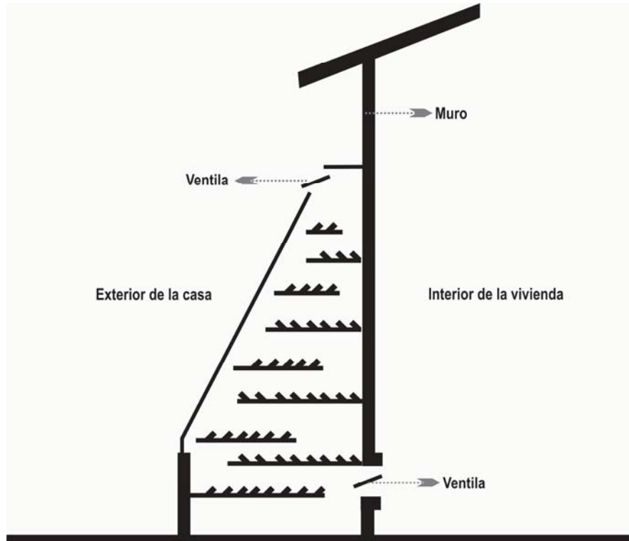
Fig. 8. Diseño del sistema pasivo propuesto por Cruz (2006) para regenerar el desecante. Fuente: Cruz (2006).
