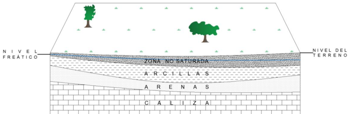
Figura 2.3 Representación esquemática de un acuífero semiconfinado
