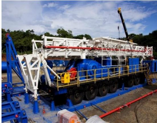
**Ilustración 3.10** Equipo de perforación autotransportable.<sup>7</sup>
