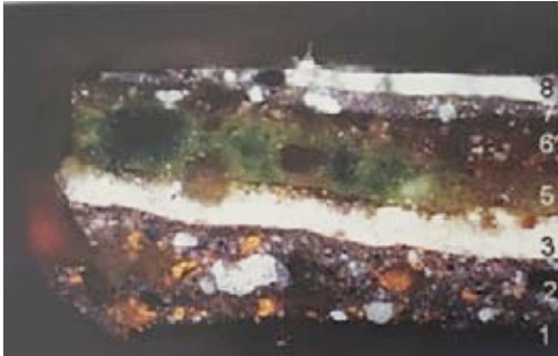
Imagen 6: Corte estratigráfico (Carnaciones). 1. Negro carbón, 2. Mezcla de albayalde, negro carbón, calcita y minio (fondo de carnación), 3. Rosado con albayalde, calcita y laca roja, 4. Barniz oleoso y 7. Gris verdoso con calcita, albayalde, índigo y negro carbón.
