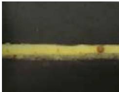
(Muestra de: "San Justo y Pastor") Capa 1. Base de preparación, 2. Gris, 3. Amarillo, 4. Blanco.
