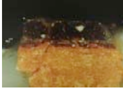
(Muestra de: "La última comunión de san Buenaventura") Capa 1. Base preparación, 2. Rosa medio, 3. Azul medio, 4. Violeta.
