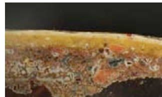
(Muestra de: "Adoración de los pastores") Capa 1. Base de preparación, 2. Ocre, 3. Encarnacion rosada.
