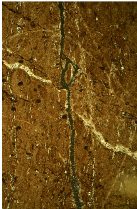
Figura 30 Lamina delgada nicoles cruzados muestra CC-03, otra área donde se puede ver la laminación, los rellenos de calcita paralelos a la laminación y la vetilla de calcita desplazada y trunca por una fractura sin relleno. (Objetivo de 4x)
