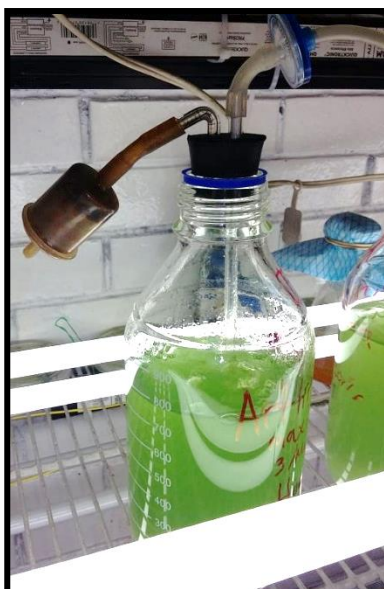
Figura 7. Unidad experimental, botella de vidrio redonda (Schott-Duran ®) con una trayectoria de luz de 11 cm y un volumen de trabajo de 900 ml (biorreactor), presenta un sistema de aireación que cuenta con un filtro con apertura de 0.25 \mu\text{m} .
