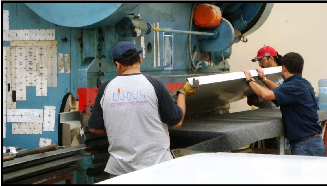
Construcción - Foto 9. Fabricación de paneles de muro de una pieza de 3.60 m de largo. Nótese que se requieren tres personas para el proceso de doblado.
