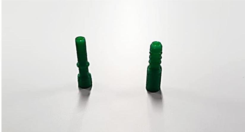
Figura 39. Acoples para bomba de combustible fabricados utilizando impresión 3D
