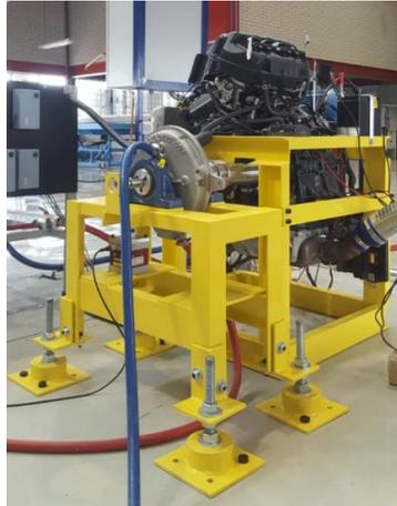
Figura 47. Ensamble final del banco de pruebas
