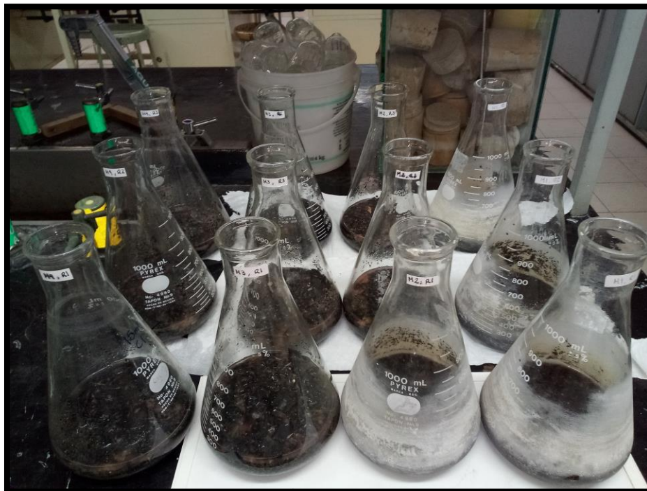
Figura 3. 14. Doce reactores preparados con la mezcla de FO+inóculo+agropásticos en las proporciones adaptadas de la norma ASTM D5526-12
