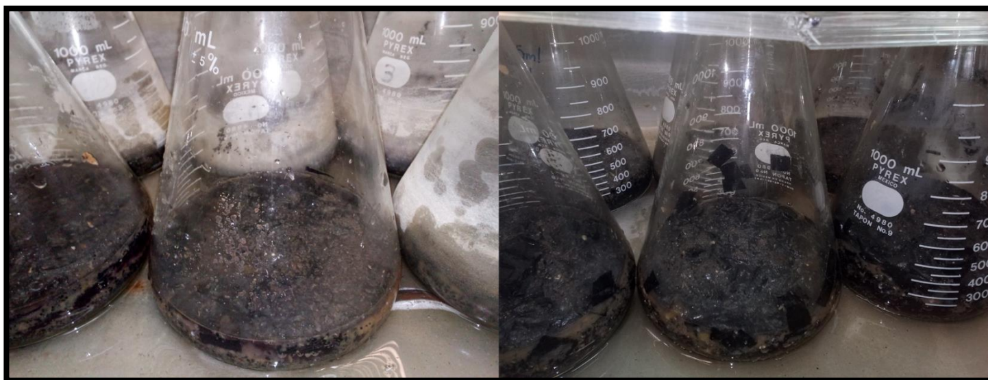
Reactores con mezclas de FO+Inóculo+Sustrato dentro del baño María
