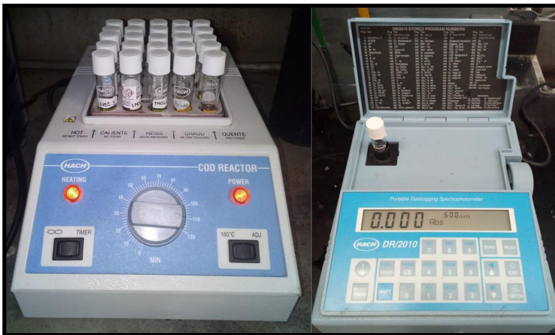
Equipo utilizado para la determinación de DQO
