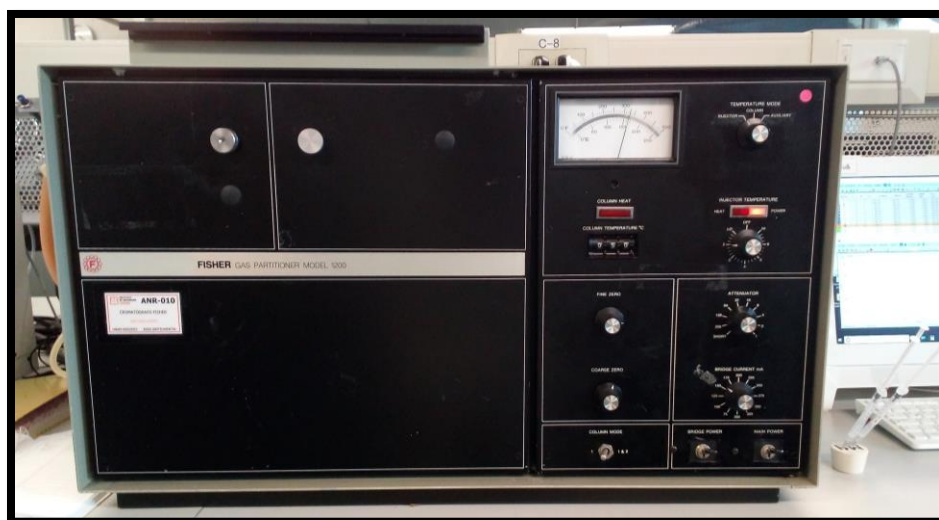
Figura 3. 22. Cromatógrafo de gases donde se analizó la composición del biogás
