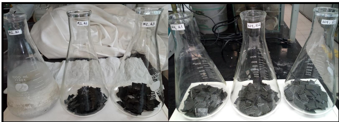
Figura 3. 15. Reactores con agropástico convencional (izquierda) y biodegradable (derecha)
