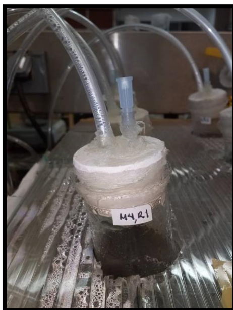
Figura 3. 18. Punzocat acondicionado para tomar la muestras de biogás
