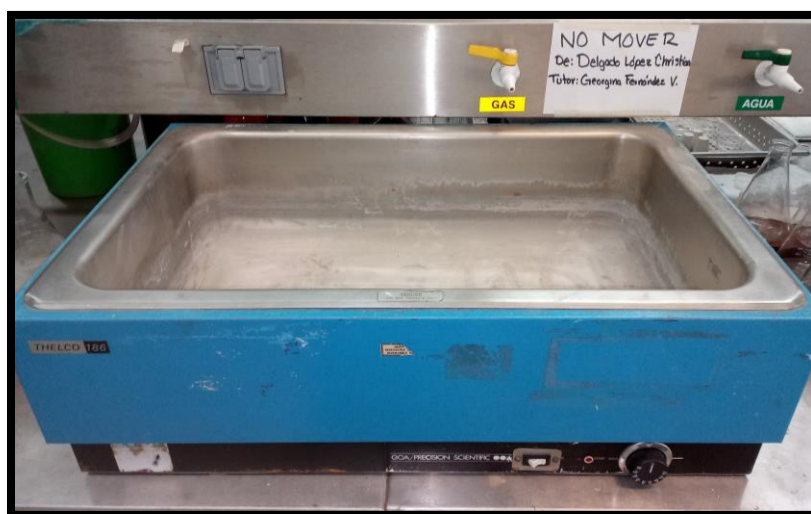
Figura 3. 17. Baño María donde se instalaron los reactores para las pruebas de biodegradación de muestras agroplásticas.
