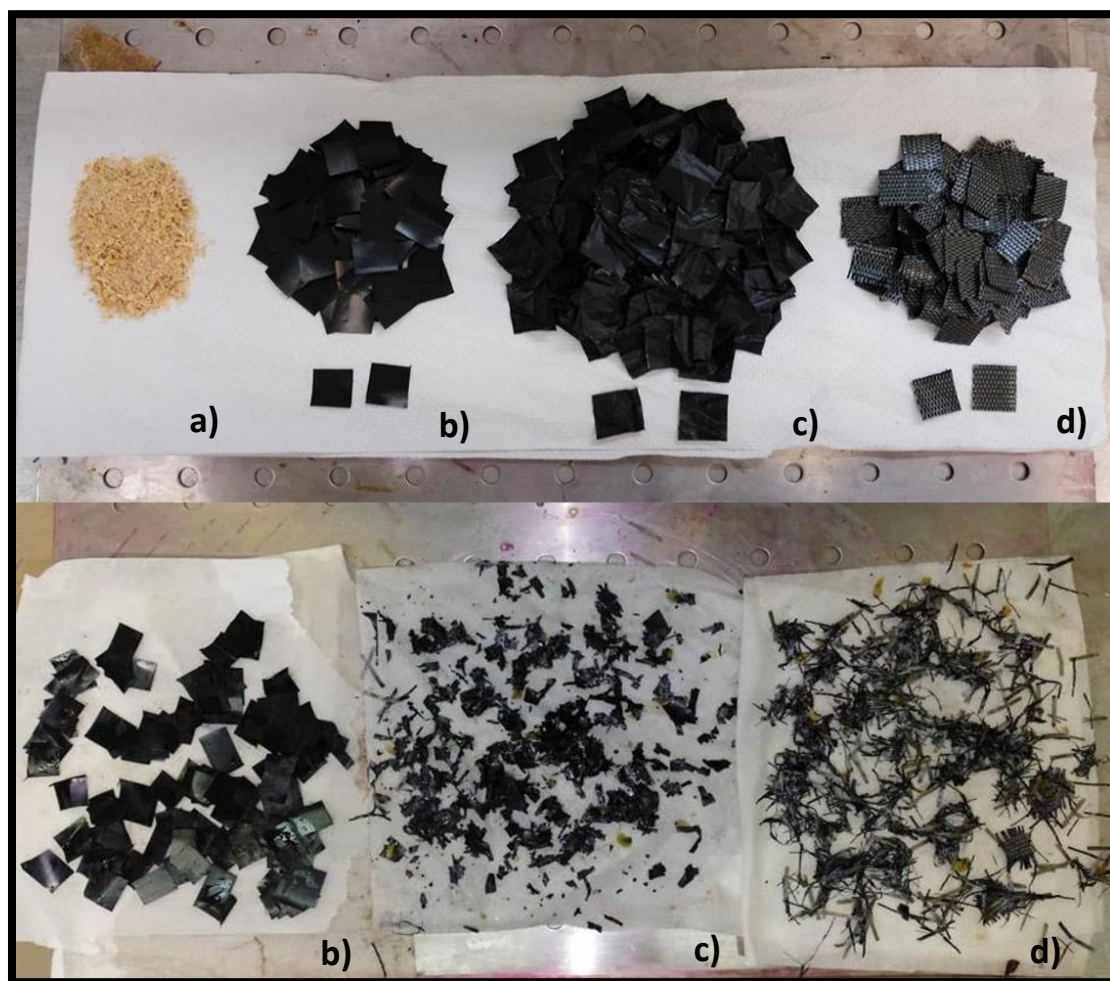
Figura 4. 5. Antes (foto superior) y después (foto inferior) del material de prueba luego del proceso de biodegradación: a) celulosa o aserrín (S1), b) agroplástico convencional (S2), c) agroplástico biodegradable proveedor 1 (S3) y d) agroplástico biodegradable proveedor 2 (S4)
