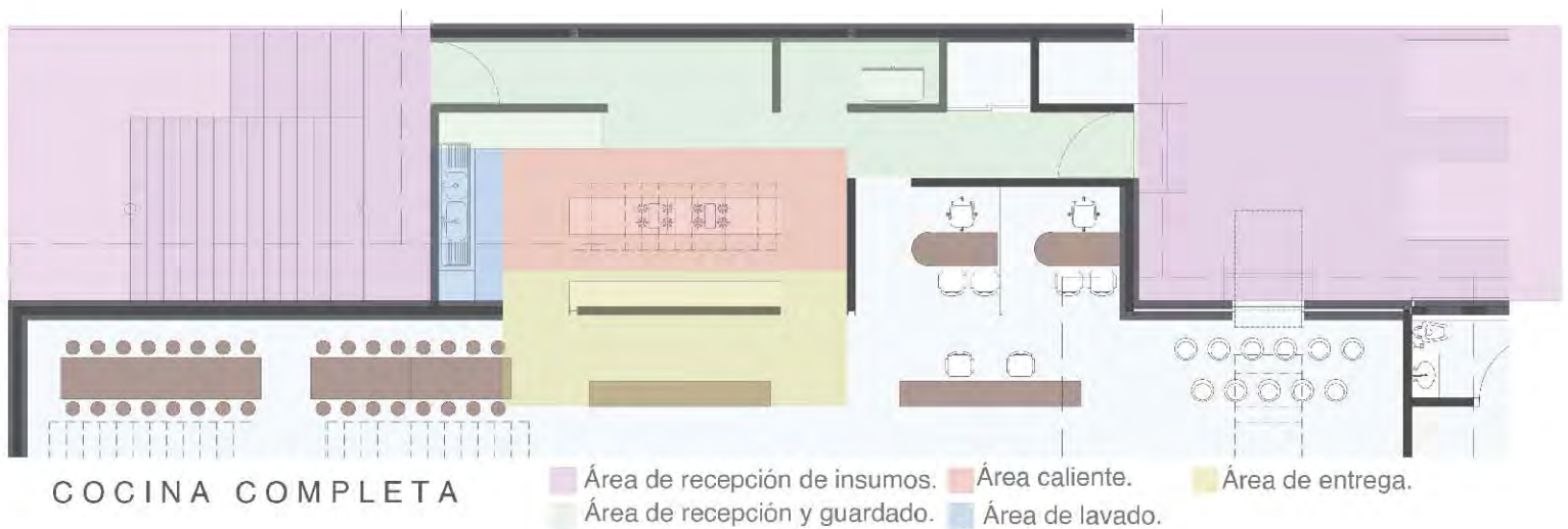
Figura 4.1. Croquis de zonificación de cocina completa.
