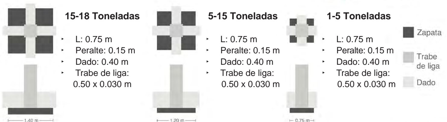
Figura 6.4. Croquis de predimensionamiento de zapatas aisladas.
