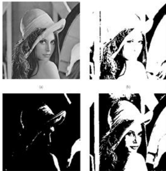
Ilustración 27 Distintos umbrales en la binarización de una imagen.
