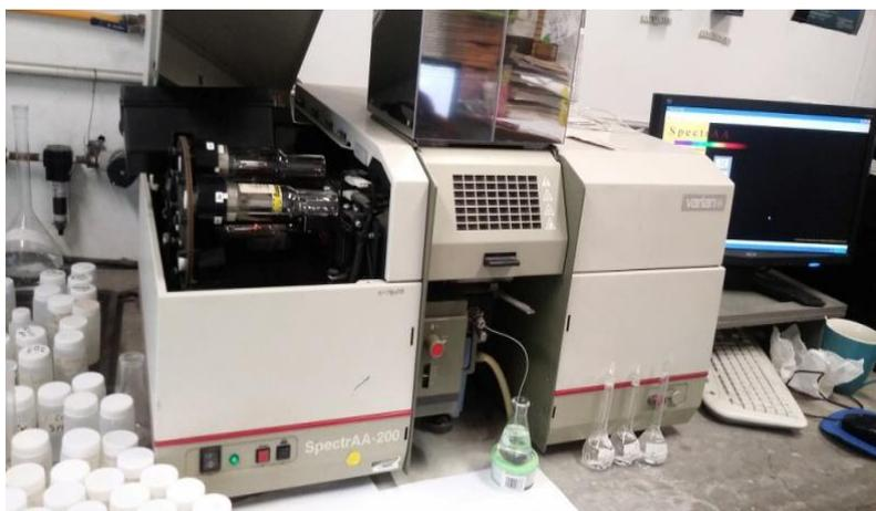
**Figura 22.** Análisis de metales (Cd, Pb, Zn y Cu) por espectroscopia de absorción atómica.
