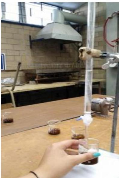
**Figura 20.** Medición de la capacidad media de amortiguamiento en corteza de *Callitropsis* sp.
