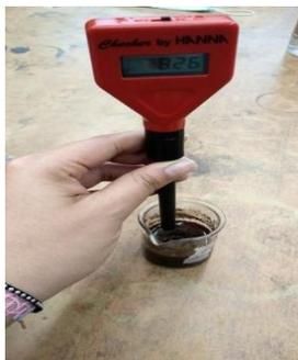
**Figura 18.** Medición de pH en corteza de corteza de *Callitropsis* sp.
