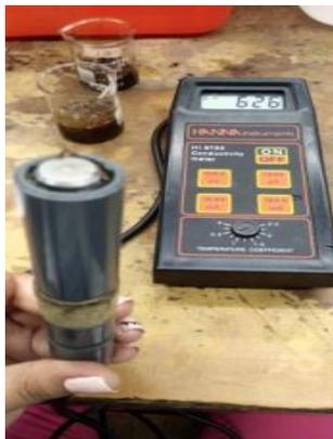
Figura 19. Medición de la conductividad eléctrica en corteza de *Callitropsis* sp.
