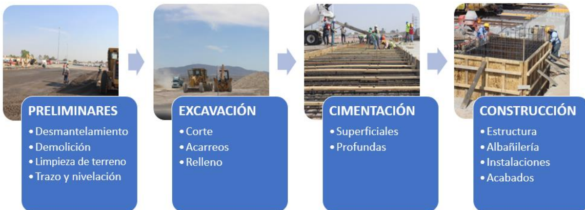
Fig. 2.4 Clasificación de etapas constructivas
