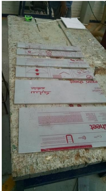
Figura 49. Cortes finales de policarbonato dos.
