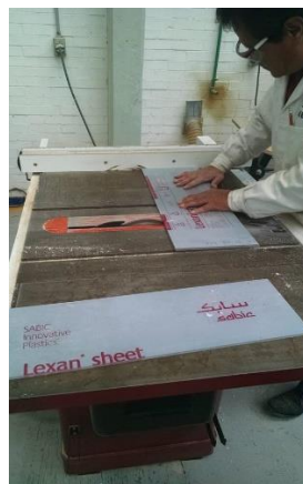
Figura 47. Proceso de corte tres en hoja de policarbonato.
