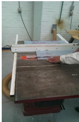
Figura 46. Proceso de corte dos en hoja de policarbonato.
