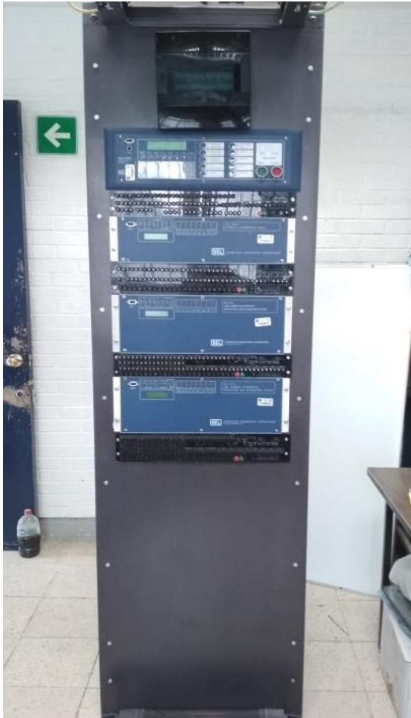
Figura 84. Presentación frontal de gabinete contando con todos los equipos. Nota: En ella se muestra el montaje final y fijación a la caratula principal de todos los equipos contando con la distribución correcta entre cada uno de ellos.
