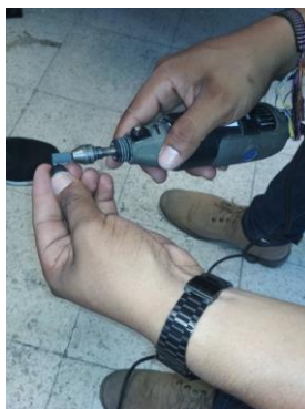
Figura 61. Desbaste de recubrimiento de plástico a plugs.
