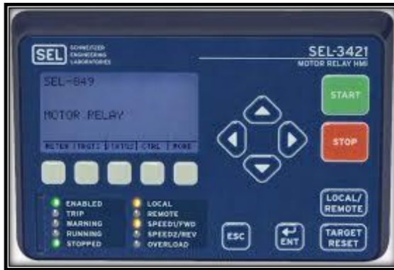
Figura 41. Representación de panel del módulo HMI del relevador digital.
