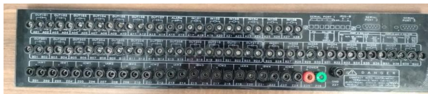
Figura 63. Montaje final de plugs en panel de policarbonato SEL-387A.
