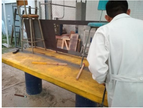
Figura 37. Proceso aplicación de primer de relleno a caratula principal.
