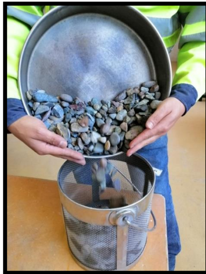
Figura 4.1.17. Colocando el material en la canastilla.
