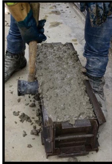
Figura 2.5.19. Dando golpes en molde prismático.
