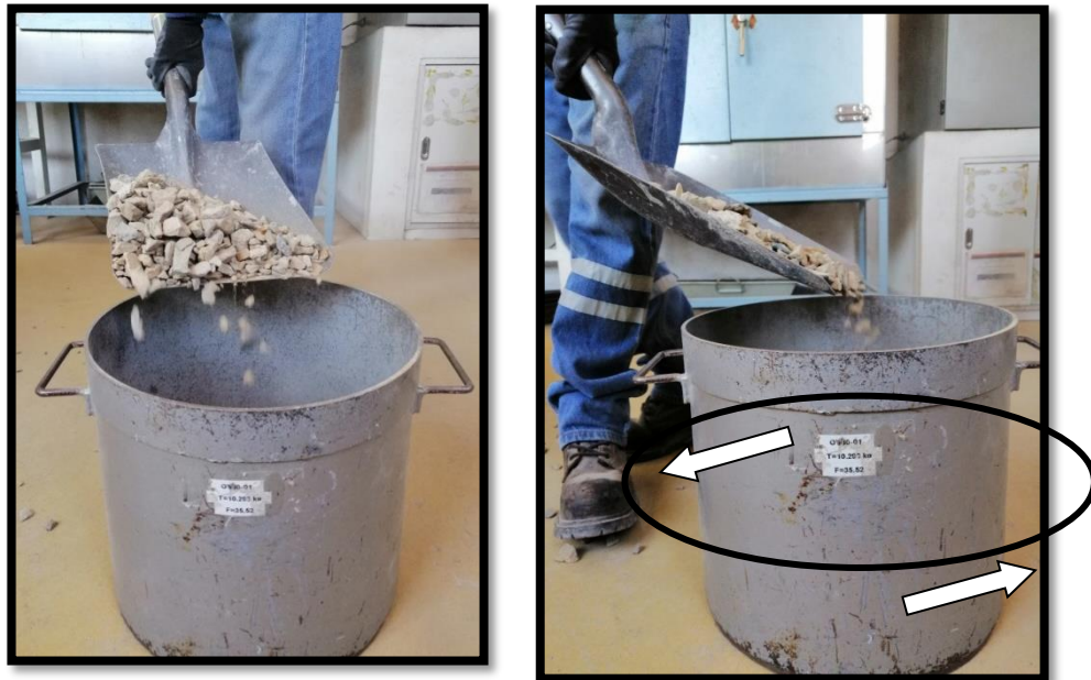
Figura 4.3.17. y 4.3.18. Como se puede observar para agregado con tamaño mayores de 40 mm, el recipiente a utilizar es de gran capacidad, en este caso se recomienda llenar el recipiente con una pala de tal manera que al llenar este, uno gire junto con la pala de tal manera que se distribuya el agregado uniformemente.
