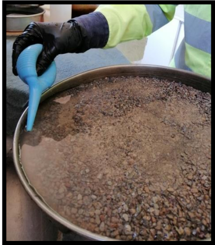
Figura 4.2.12. Decantar el exceso de agua.
