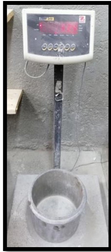
Figura 2.2.39. Obteniendo el peso del recipiente
