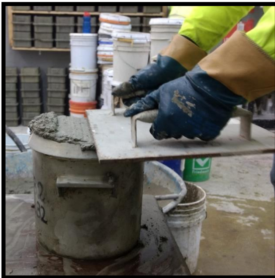
Figura 2.2.23. Avanzando con movimiento de sierra hacia abajo.
