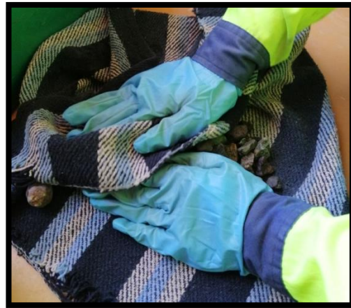
Figura 4.1.13. Para que pierdan el brillo acuoso se utiliza una tela húmeda.
