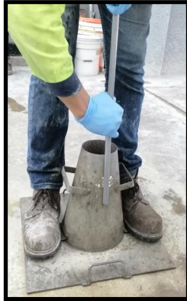
Figura 2.1.21. Medición de la varilla, para la tercera capa.
