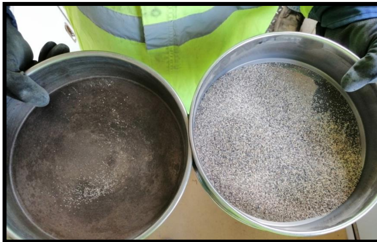
Figura 4.4.8. Se puede observar que ya no pasa más del 1% de la masa que retiene la criba.
