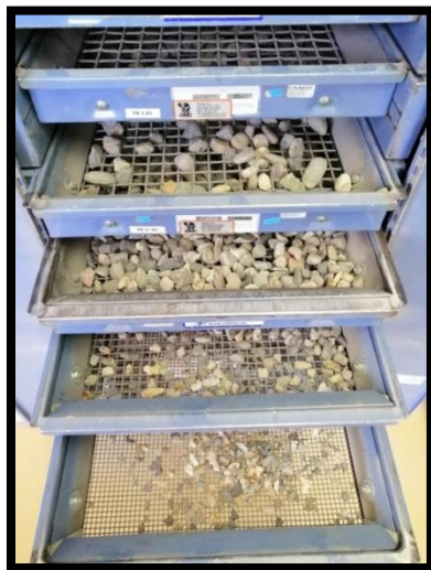
Figura 4.4.10. En una máquina de cribado de agregado grueso así se ve la distribución del agregado en cada criba.
