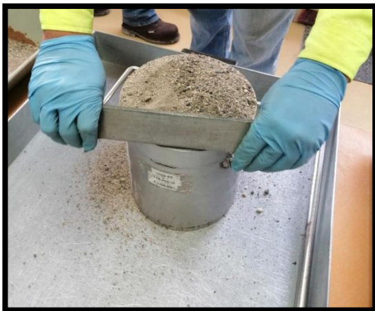
Figura 4.3.10. y 4.3.11. Enrase mediante corte horizontal.
