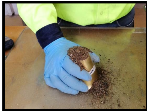
Figura 4.2.20. Llenado hasta que sobrepase el borde superior.
