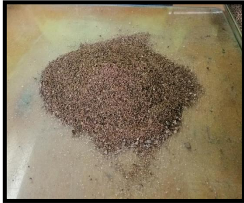
Figura 4.2.36. Se perdió humedad de más, ya que hay un completo abatimiento.
