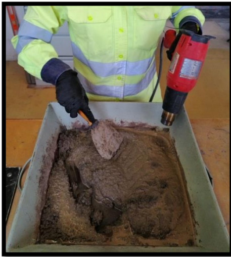
Figura 4.2.16. Si tu muestra está muy húmeda, se puede poner la pistola muy cerca del agregado para que lo pueda secar más rápido.
