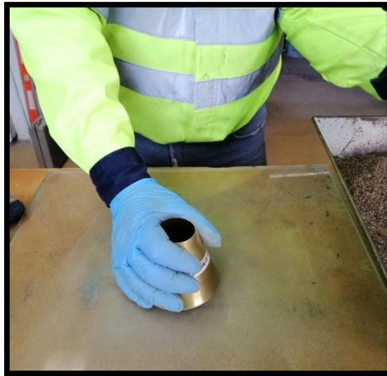
Figura 4.2.18. Fijar firmemente el molde con una superficie lisa.
