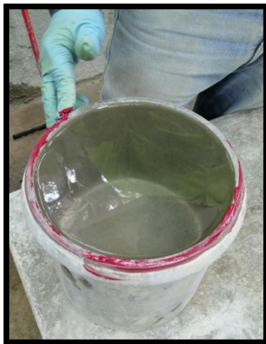
Figura 2.2.41. Colocando grasa en todo el borde superior del recipiente.
