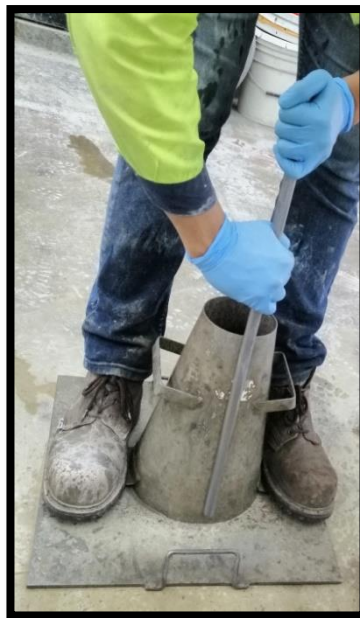
Figura 2.1.17. Medición de la varilla, para la primera capa.
