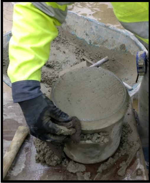
Figura 2.2.33. Limpiar los excesos de concreto que queden.
