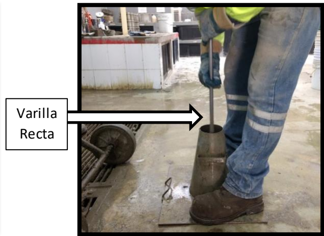
Figura 2.1.12. La otra mitad de las compactaciones con la varilla lo más recta posible avanzando en espiral hacia el centro.
