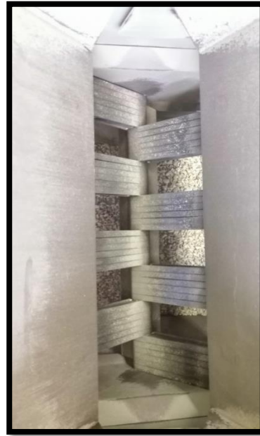
Figura 4.1.6. Para agregado grueso, el número de conductos no debe ser menor a 8.
