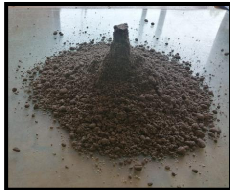
Figura 4.2.34. y 4.2.35. En ese caso las dos arenas presentadas son andesitas pero al levantar el cono estas se disgregaron de diferente forma y esto depende de la cohesión y trituración del agregado.
