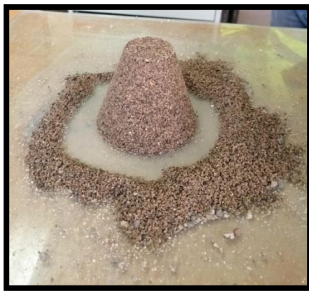
Figura 4.2.30. Agregado todavía con exceso de humedad, ya que conserva la forma del cono.
