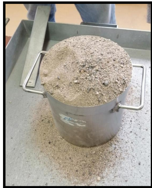
Figura 4.3.6. y 4.3.7. En ambos caso tanto agregado grueso como fino, así se deberá ver la tercera capa con material que sobre pase el borde
