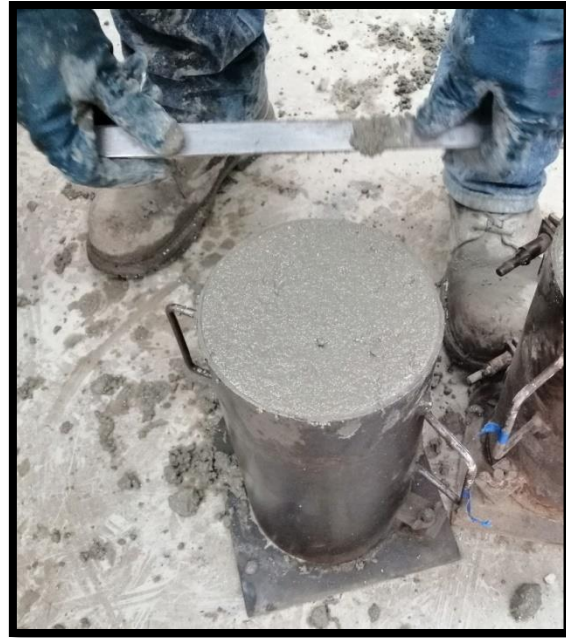
Figura 2.5.24. Enrasado en forma de cierra. Figura 2.5.25. Así se debe de ver un buen enrasado.
