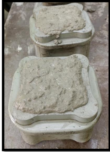
Figura 2.5.21. Superficie sin oquedades: en molde cúbico.
