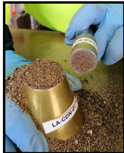
Figura 4.2.31. Si el agregado sigue húmedo, este se queda pegado en el pisón y molde.
