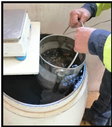
Figura 4.1.18. Sumergir la canastilla ya con el agregado incluido.
