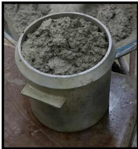
Figura 2.2.17. Aproximadamente la altura de la tercera capa.
