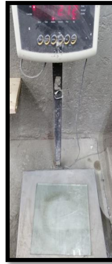
Figura 2.2.40. Obteniendo el peso de la placa de verificación.
