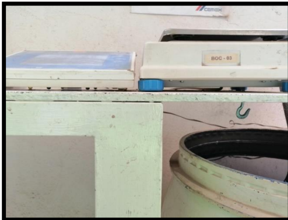
Figura 4.1.3. Dispositivo de sujeción de canastilla.
