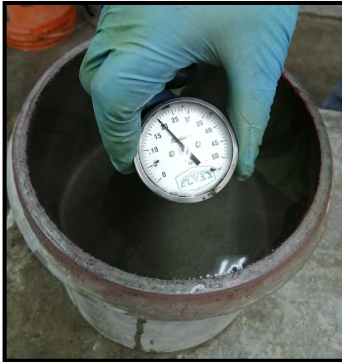
Figura 2.2.49. Obteniendo la temperatura del agua.
