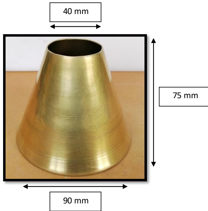
Figura 4.2.1. Medidas del molde.
