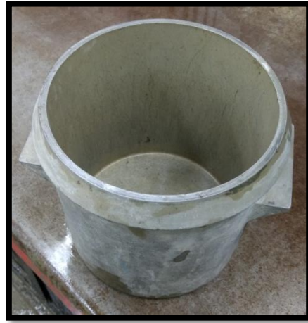
Figura 2.3.2. Recipiente con acabado maquinado y pulido.
