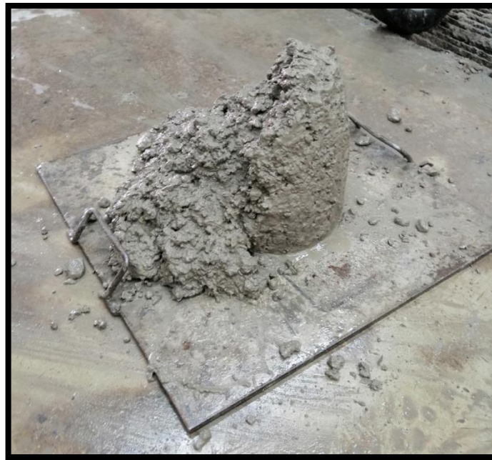
Figura 2.1.31. Revenimiento cortante ocasionado por 2 factores:
