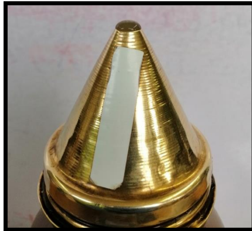
Figura 4.2.47. Así se deberá ver el nivel de aforo y cuando se tenga esta condición, se obtiene la M_{pma} .
