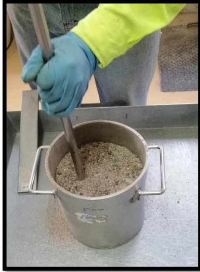
Figura 4.3.8. Penetraciones al agregado fino.
