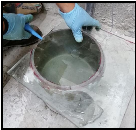
Figura 2.2.45. Eliminando las burbujas con la pipeta.
