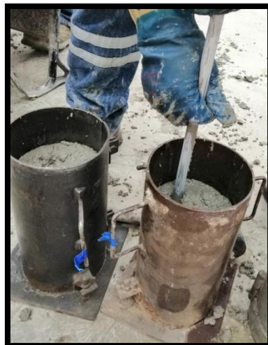
Figura 2.5.12. Compactaciones de la primera capa en espécimen cúbico con varilla corta.
