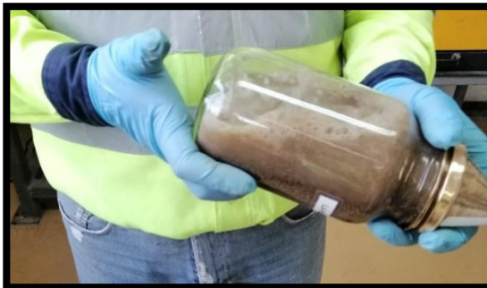
Figura 4.2.41 y 4.2.42. Se agita y se invierte de tal manera que se eliminan todas las burbujas de aire.
