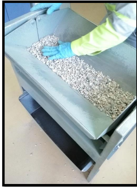
Figura 4.1.5. Para el cuarteo mecánico, el agregado se distribuye a todo lo largo del cuarteador.
