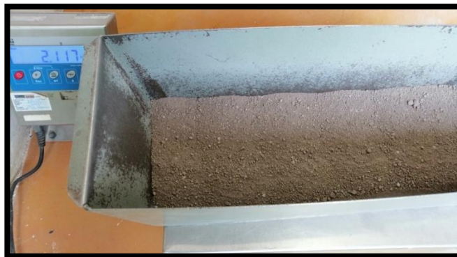
Figura 4.2.8. Para densidad de agregado fino se reduce la muestra por lo menos 2kg.
