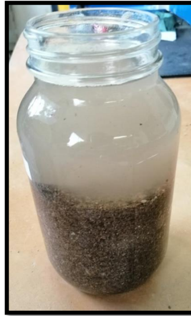
Figura 4.2.40. El agua debe tener una temperatura de 23^{\circ}\text{C} \pm 2^{\circ}\text{C} .
