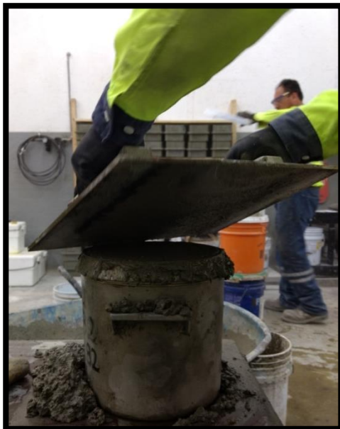
Figura 2.2.31. Enrasando en otra dirección.
