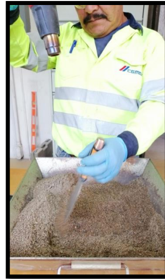
Figura 4.2.17. Si tu muestra ya es muy manejable, la pistola se debe poner a una distancia considerable para que no se pierdan finos.
