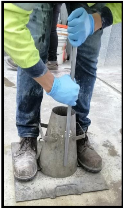
Figura 2.1.18. Medición de la varilla, para la segunda capa.
