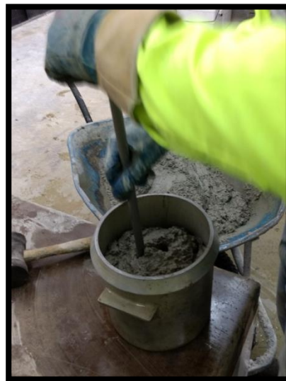
Figura 2.2.14. Realizar las penetraciones con la varilla recta.
