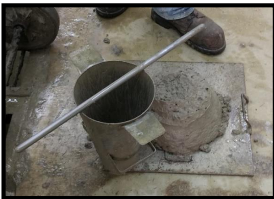
Figura 2.1.29. Medir el asentamiento a partir del nivel de la base superior del molde.
