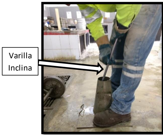
Figura 2.1.11. La mitad de las compactaciones con la varilla inclinada en la zona perimetral.
