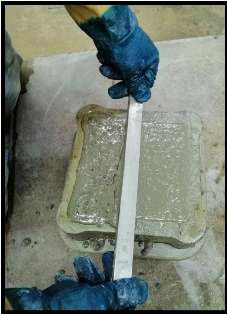
Figura 2.5.24. Enrasado en forma de cierra. Figura 2.5.25. Así se debe de ver un buen enrasado.
