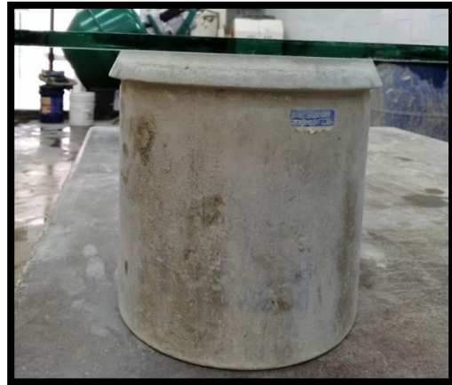
Figura 2.2.36. Esto con el fin de checar la planicidad del recipiente.
