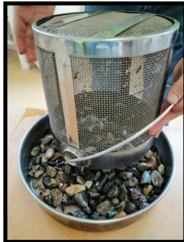
Figura 4.1.22. Después de determinar las masas necesarias para la densidad, pasar el agregado a una charola y colocar en horno hasta la masa seca " M_s ".
