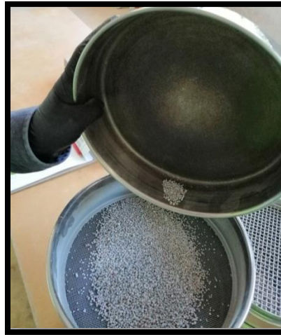
Figura 4.4.9. Lo que pase la malla, se le anexa a la siguiente criba.
