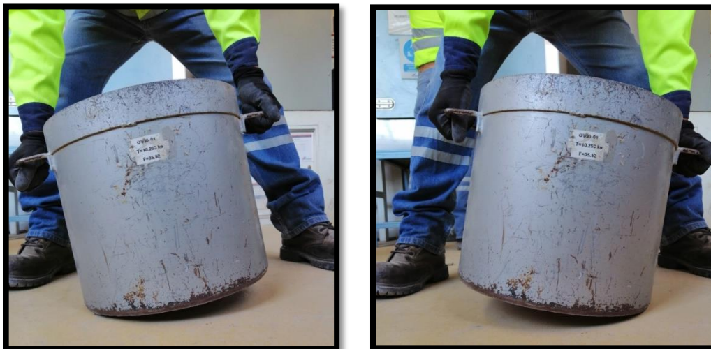
Figura 4.3.19. y 4.3.20. Compactación por impactos alternando los 50 golpes de cada lado del recipiente.
