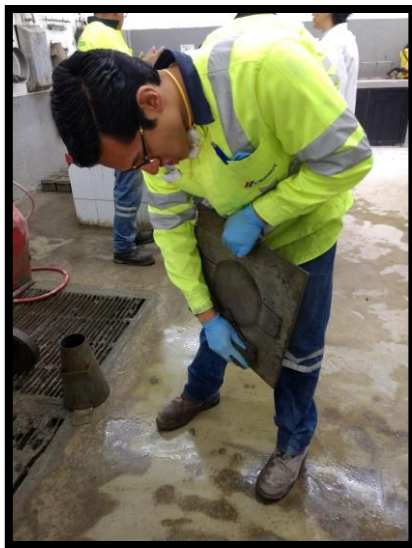
Figura 2.1.6. Humedecer la placa o superficie.
