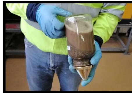
Figura 4.2.41 y 4.2.42. Se agita y se invierte de tal manera que se eliminan todas las burbujas de aire.
