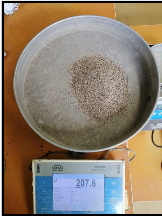
Figura 4.2.50. Del material en SSS, pesar mínimo 200 gr para determinar la absorción.
