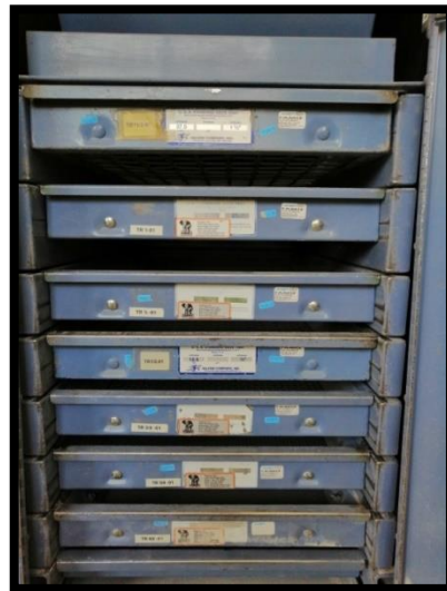
Figura 4.4.6. Agitación de agregado grueso por medio de un aparato mecánico.
