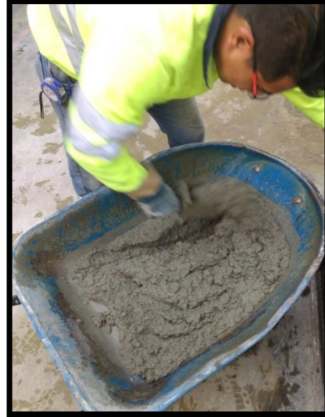
Figura 2.1.5. Después del remezclado
