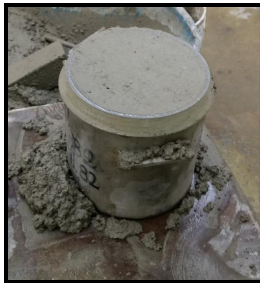
Figura 2.2.32. Aproximadamente así se debe de ver un enrase final.
