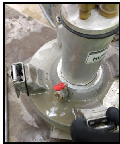
Figura 2.3.10. Agua saliendo por la Válvula B.
