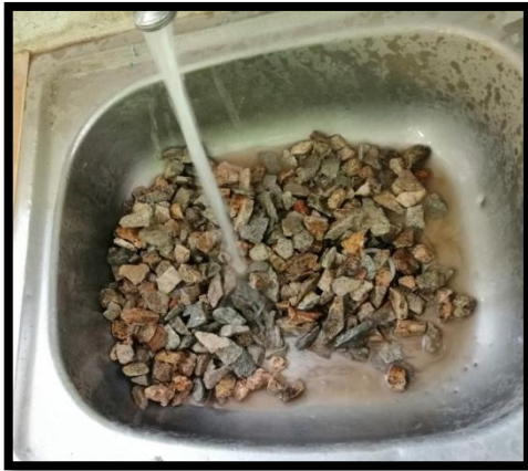
Figura 4.1.9. Lavar el agregado grueso.
