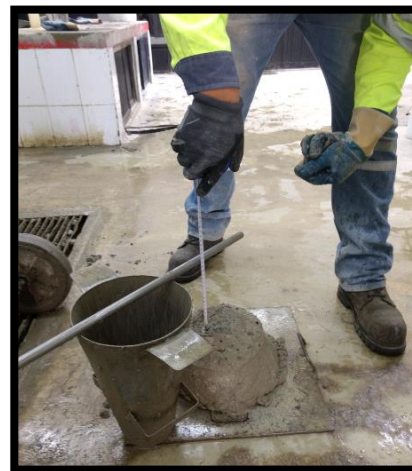
Figura 2.1.30. Hacer la medición de la diferencia de alturas desde el centro desplazado.
