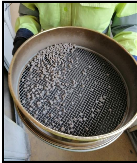
Figura 4.2.9. Al cribar por Malla No.4, lo que se queda retenido en tal malla, ya forma parte del agregado grueso por lo cual se desecha.
