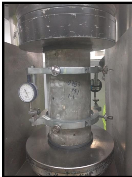
Figura 3.2.12. Especimen en el centro de la platina, asegurando las superficies limpias tanto de la platina como del espécimen.
