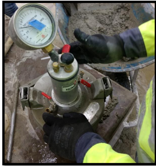
Figura 2.3.15. Se golpean los lados del recipiente para distribuir presiones.
