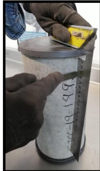
Figura 3.1.5. Revisando la perpendicularidad en otro punto.
