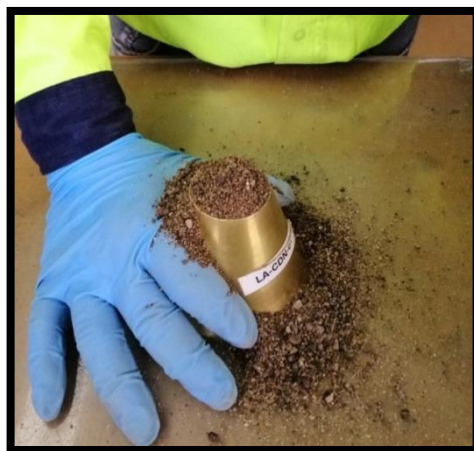
Figura 4.2.22. Llenado hasta que sobrepase el borde superior.
