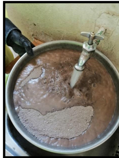
Figura 4.2.11. Saturar el agregado de agua por lo menos 20 mm.
