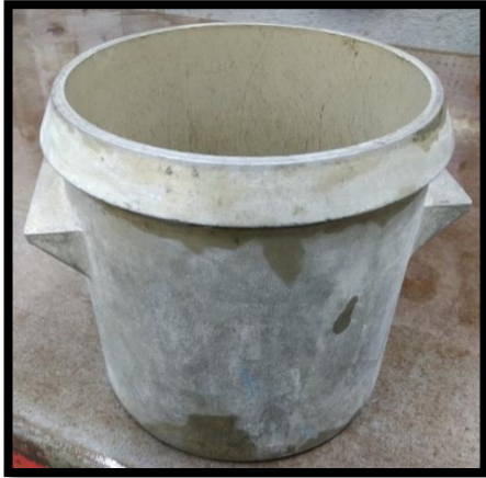
Figura 2.2.6. Recipiente o unidad de medición.
