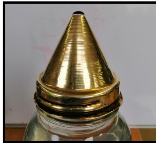
Figura 4.2.49. Así se deberá ver el nivel de aforo y cuando se tenga esta condición, se obtiene la M_{pa} .
