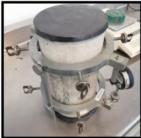
Figura 3.2.9. Colocando los deformímetros de manera que el espécimen quede en el centro de los anillos.
