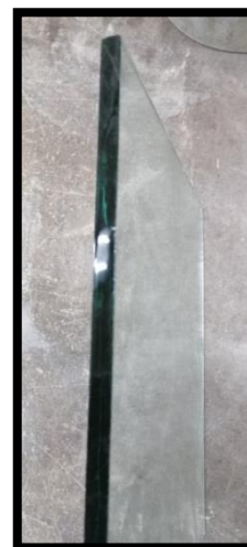
Figura 2.2.5. Espesor de placa de verificación de 6 mm de espesor.
