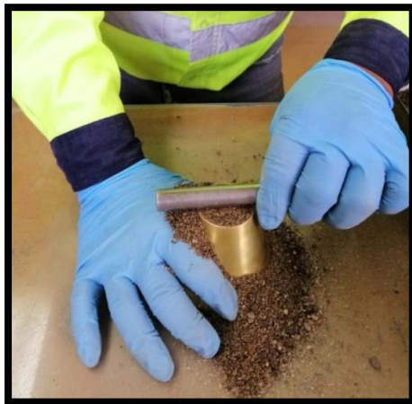
Figura 4.2.25. Enrasando con el pisón.
