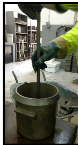
Figura 2.2.10. Realizar las penetraciones con la varilla recta.
