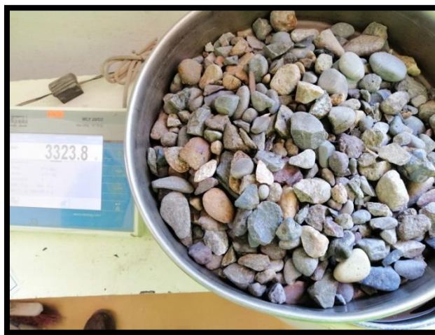
Figura 4.1.16. El agregado mostrado es de 20 mm por lo cual su masa mínima que debe tener son 3 kg.
