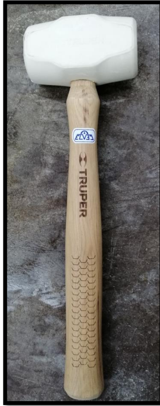
Figura 2.5.8. Mazo con cabeza de neopreno.
