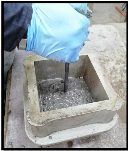
Figura 2.5.12. Compactaciones de la primera capa en espécimen cúbico con varilla corta.
