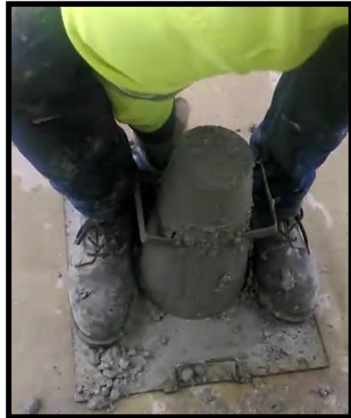
Figura 2.1.26. Limpiando exceso de la placa.
