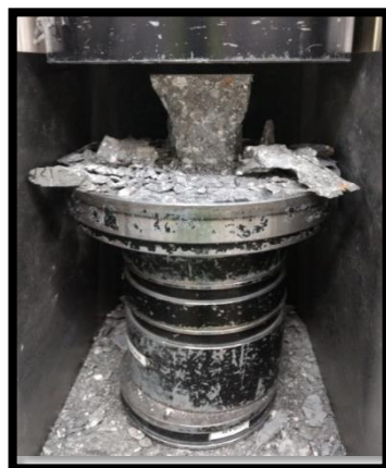
Figura 3.1.22. Estallido de espécimen cubico de 10x10 con una f'_c alrededor de 800 kg/cm 2 .
