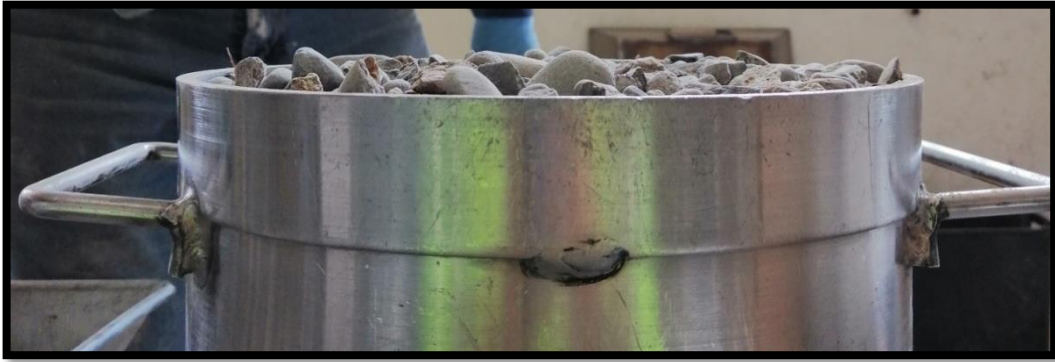
Figura 4.3.15. Aproximadamente así se debe de ver un enrase de agregado grueso donde se compensan lo saliente con las depresiones sobre el borde.
