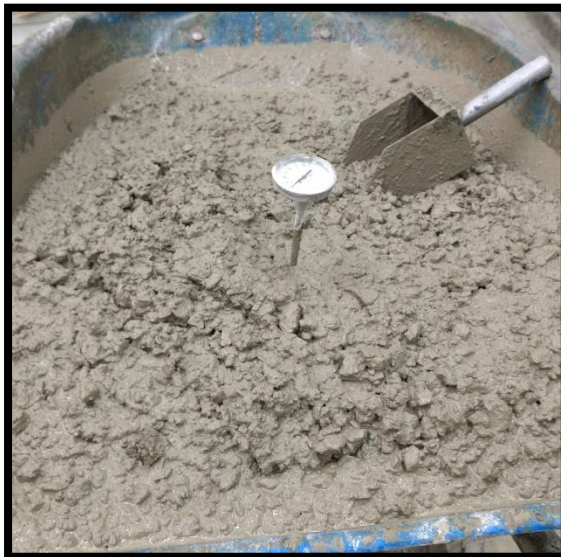
Figura 2.4.3. Colocación del vástago en el concreto intentando que este quede lo más vertical posible.
