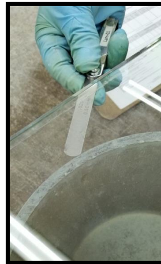
Figura 2.2.38. Tratando de hacer pasar la laminilla entre el recipiente y la placa.
