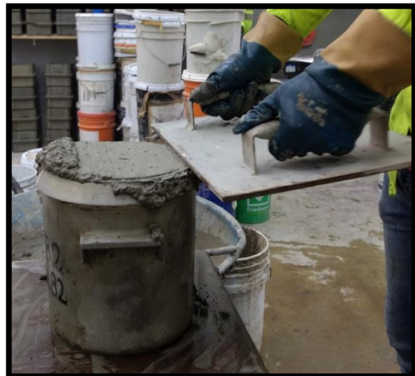
Figura 2.2.24. Terminar los movimientos de sierra hasta que quede afuera la placa.
