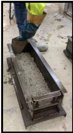
Figura 2.5.16. En moldes prismáticos se recomienda usar cuchara de albañil.
