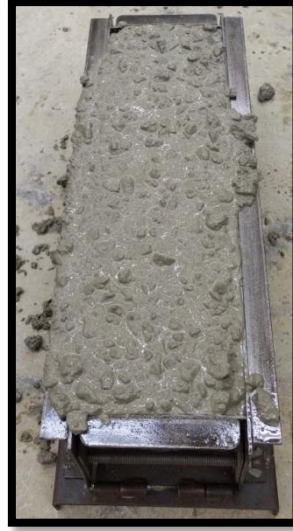
Figura 2.5.22. Superficie sin oquedades en molde prismático.
