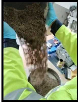
Figura 4.2.32. y 4.2.33. Cuando le falta poco para estar en SSS, se pasa de un recipiente a otro y viceversa.
