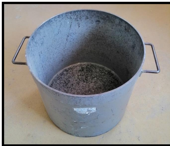
Figura 4.3.16. Recipiente para agregado con tamaño máximo nominal mayor de 40 mm.
