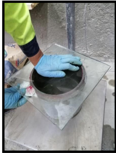
Figura 2.2.47. Limpiando el exceso de agua y grasa.
