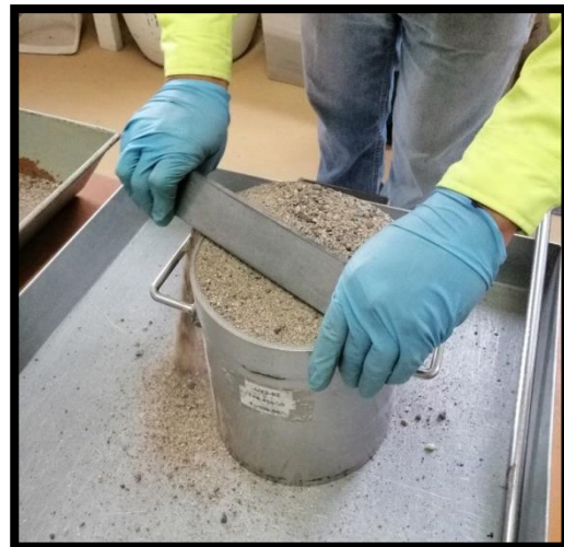
Figura 4.3.10. y 4.3.11. Enrase mediante corte horizontal.
