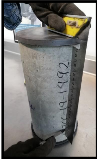
Figura 3.1.4. Revisando la perpendicularidad en un punto.
