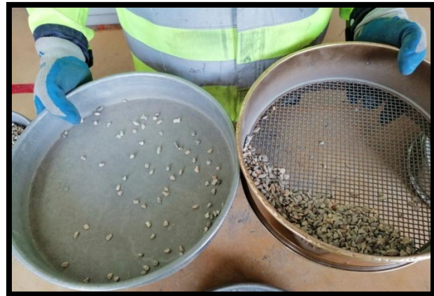
Figura 4.1.8. Lo que pasa la Malla No. 4 ya entra en el rango de las arenas por lo cual se desecha de la muestra.
