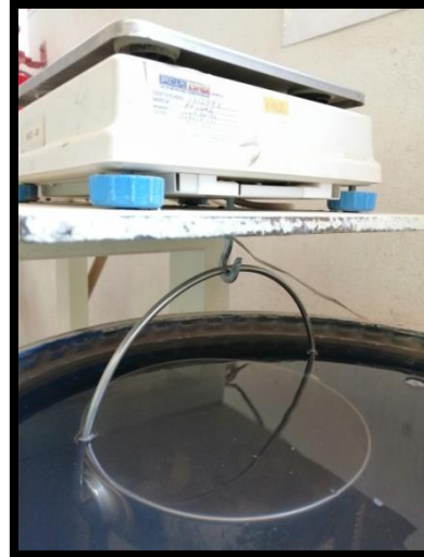
Figura 4.1.21. Obtener la masa bruta "b".
