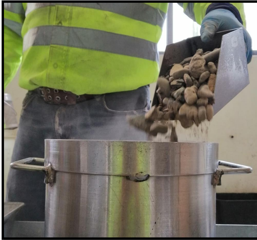
Figura 4.3.23. Dejando caer el agregado a una altura no mayor a 50 mm entre el cucharón y el borde del recipiente.
