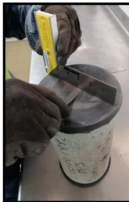
Figura 3.1.3. Revisando la planicidad en otra dirección.
