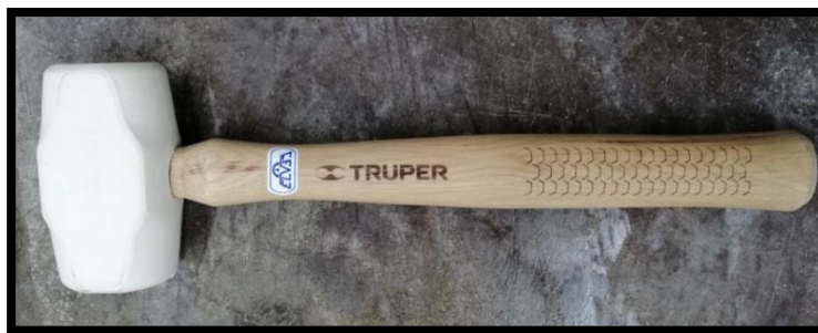
Figura 2.2.1. Mazo con cabeza de neopreno.
