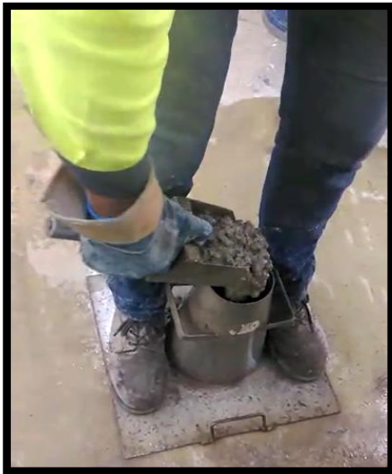
Figura 2.1.15. Vaciado con el cucharón.
