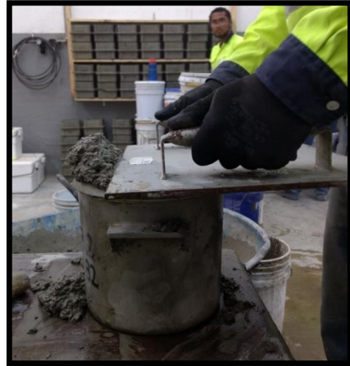
Figura 2.2.22. Colocación de la placa a 2/3 de la superficie.
