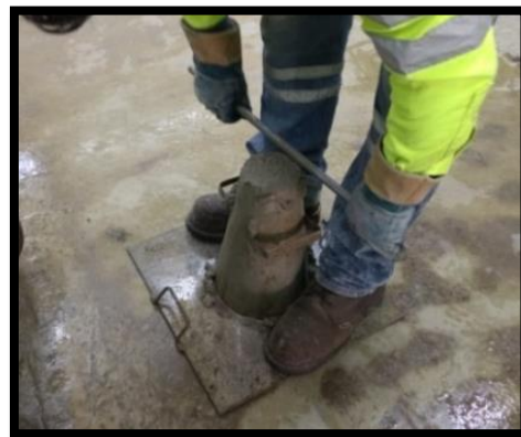
Figura 2.1.24. Acabado mediante rodamiento de varilla.
