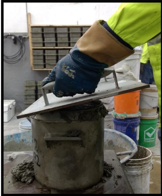
Figura 2.2.29. Inclinando el canto de la placa.
