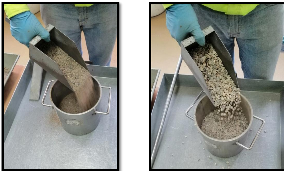
Figura 4.3.21. y 4.3.22. Llenando en una sola capa a una velocidad constante para una distribución proporcional.
