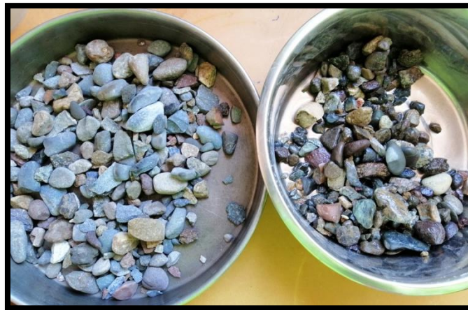
Figura 4.1.14. Del lado derecho se muestra el agregado grueso saturado y del lado izquierdo se presenta el agregado en SSS.
