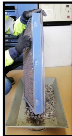
Figura 4.4.11. Y lo retenido de cada malla se pasa en una charola para pesar lo retenido.
