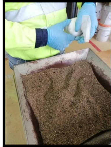
Figura 4.2.37. Si ocurre un abatimiento, agregar agua y remezclar.
