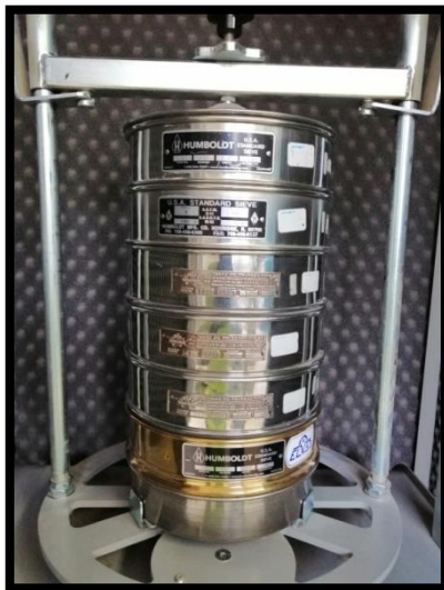
Figura 4.4.5. Agitación de agregado fino por medio de un aparato mecánico.
