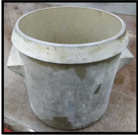
Figura 2.3.1. Recipiente medidor de capacidad de 7 litros.
