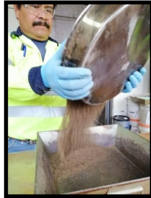
Figura 4.2.32. y 4.2.33. Cuando le falta poco para estar en SSS, se pasa de un recipiente a otro y viceversa.
