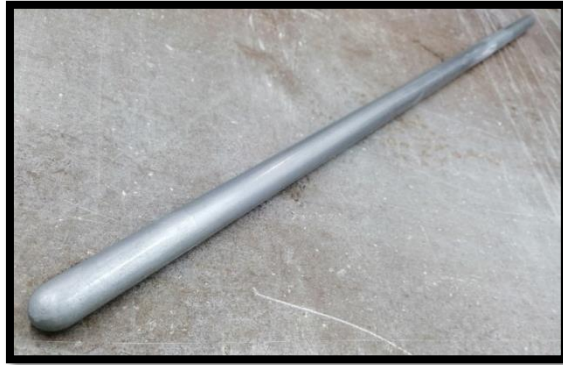
Figura 2.2.8. Varilla de compactación con punta semiesférica.
