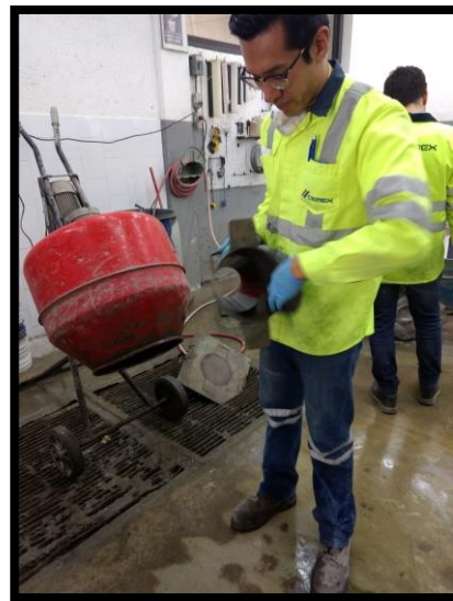
Figura 2.1.7. Humedecer el cono de revenimiento.
