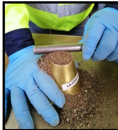
Figura 4.2.26. Cuidando de no ejercer presión sobre el material.
