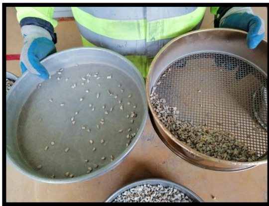
Figura 4.4.15. Lo que pasa la criba se le anexa a la siguiente criba.
