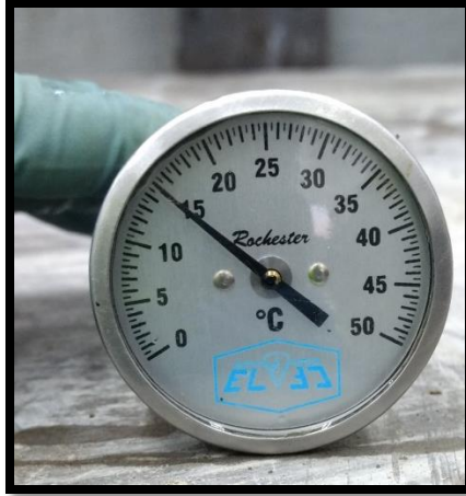
Figura 2.4.2. Dispositivo de lectura con intervalo de 0°C a 50°C.
