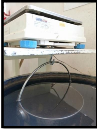
Figura 4.1.15. Obtener el peso de la canastilla "t".
