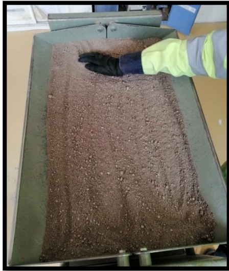
Figura 4.2.6. Para el cuarteo mecánico, el agregado se distribuye a todo lo largo del cuarteador.
