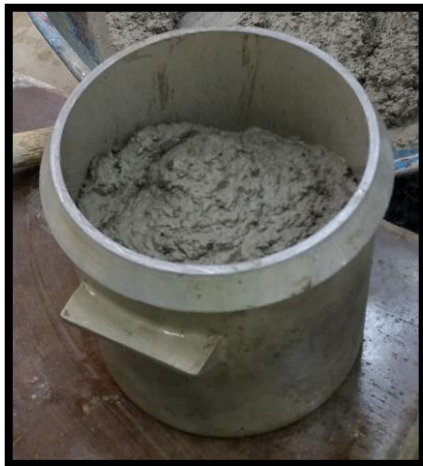
Figura 2.2.13. Aproximadamente la altura de la segunda capa.
