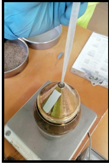
Figura 4.2.46. Se termina de llenar a nivel de aforo.
