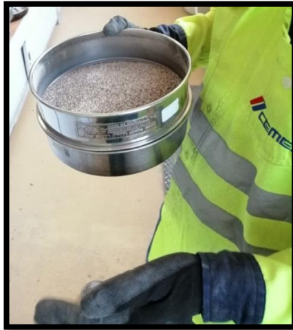
Figura 4.4.7. Se reciba cada criba individualmente con una charola de fondo, dándole un total de 150 golpes por minuto hasta que no pase más de 1% de la masa de cada criba.
