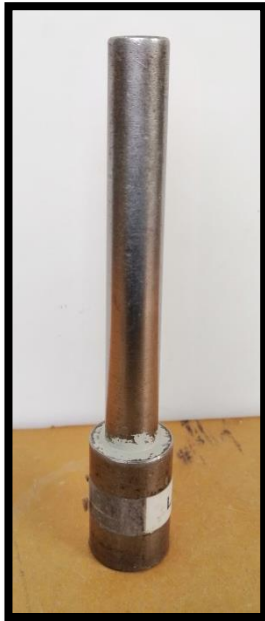
Figura 4.2.4. Pisón debe pesar 340 \text{ gr} \pm 15 \text{ gr} .
