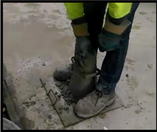
Figura 2.1.25. Limpiando exceso de la parte superior del molde.
