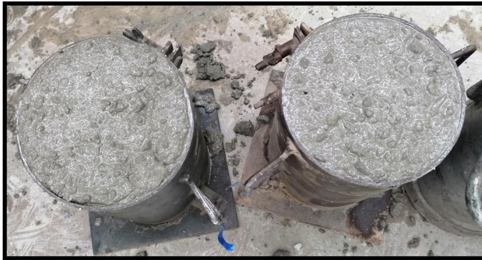
Figura 2.5.23. Superficie sin oquedades en molde cilíndrico.
