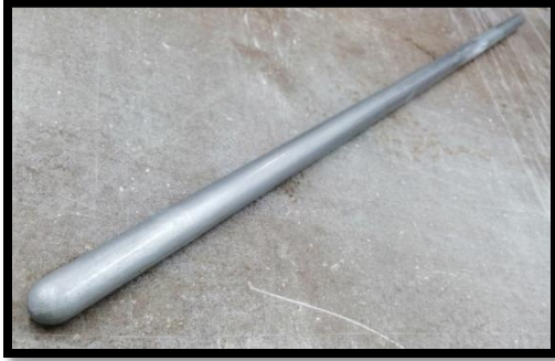
Figura 2.1.2. Varilla de compactación con punta semiesférica.
