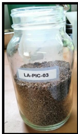
Figura 4.2.38. Introducir el material en SSS al picnómetro, aproximadamente de 700 a 800 gr.
