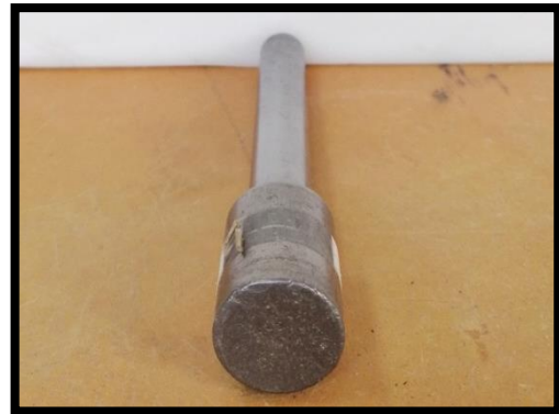
Figura 4.2.5. Pisón debe tener un diámetro de 25 \text{ mm} \pm 3 \text{ mm} .
