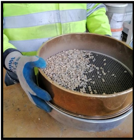
Figura 4.1.7. Cribando por malla No. 4 para eliminar tamaños menores.
