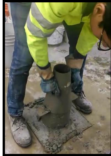
Figura 2.1.28. Levantamiento del cono en 5 seg \pm 2 seg.
