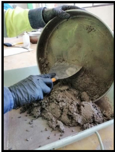
Figura 4.2.14. Pasar la muestra a una superficie lisa no absorbente, se recomienda que sea una superficie grande para poder manipular la muestra.
