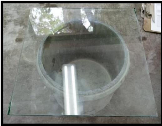
Figura 2.2.35. Placa de verificación encima del recipiente.
