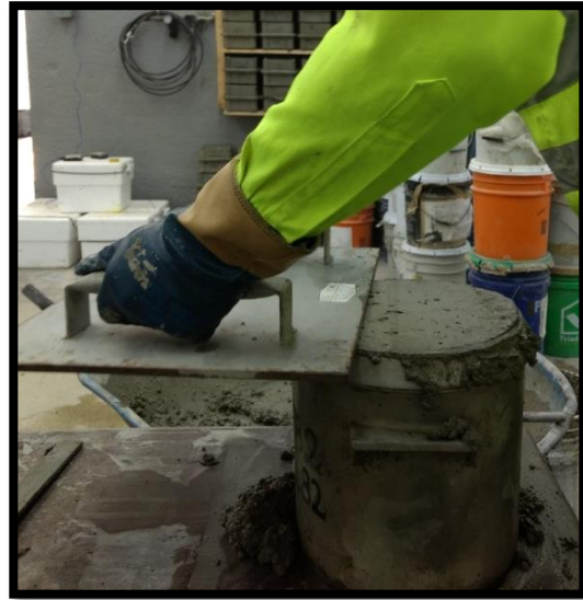
Figura 2.2.26. Avanzando con movimiento de sierra, enrasando el 1/3 faltante.
