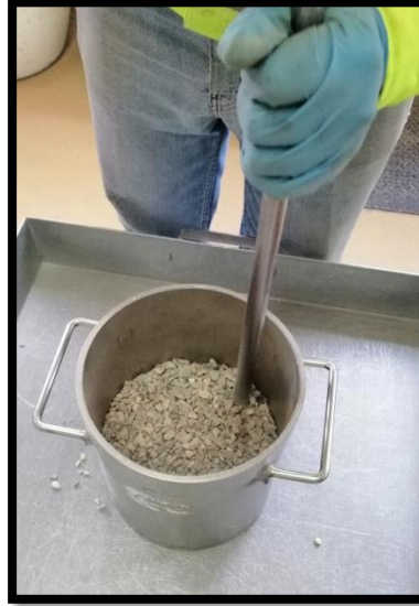
Figura 4.3.9. Penetraciones al agregado grueso.
