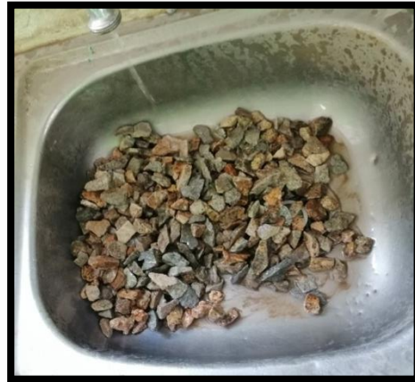
Figura 4.1.10. Lavar para eliminar polvo y material adherido.
