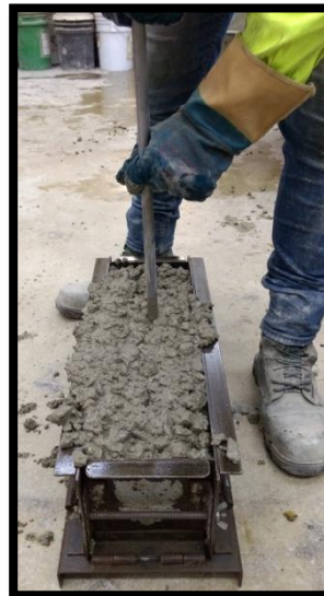
Figura 2.5.13. Compactaciones de la segunda capa en espécimen prismático con varilla larga.
