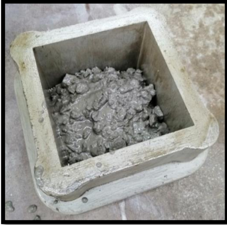
Figura 2.5.9. Altura de la primera capa en espécimen prismático.
