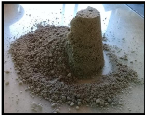
Figura 4.2.34. y 4.2.35. En ese caso las dos arenas presentadas son andesitas pero al levantar el cono estas se disgregaron de diferente forma y esto depende de la cohesión y trituración del agregado.
