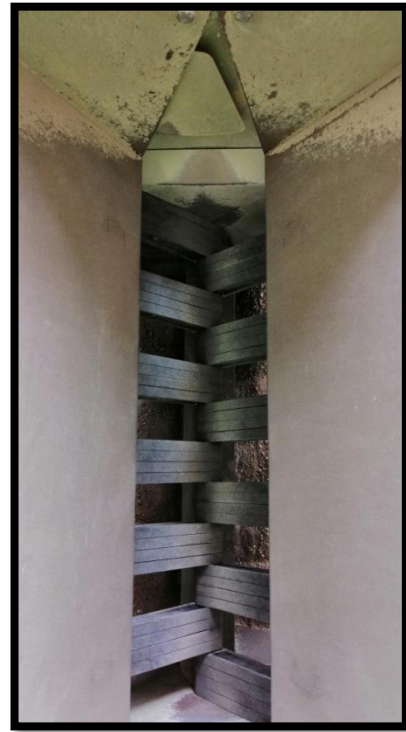
Figura 4.2.7. Para agregado fino, el número de conductos no debe ser menor a 12.
