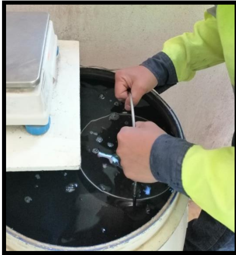
Figura 4.1.20. Observar que ya no salgan burbujas de aire, si en el dado caso que sigan saliendo burbujas de aire seguir girando la canastilla.
