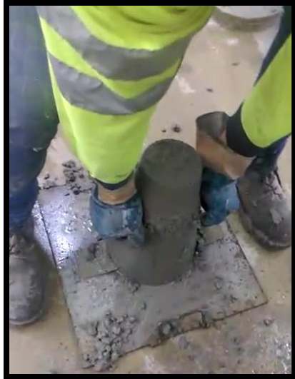
Figura 2.1.27. Primero agarrar las asas haciendo presión hacia abajo y después mover los pies en paralelo a los estribos.
