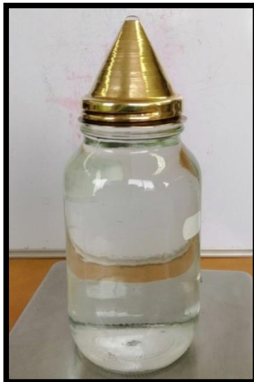
Figura 4.2.48. Así se debe de ver el picnómetro solamente con agua hasta el nivel de aforo y secado superficialmente.
