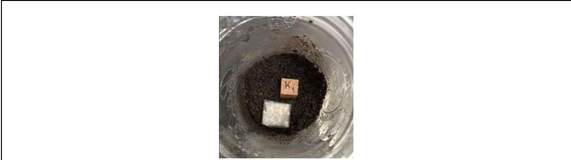
Fotografía 11: Probeta de una clase de madera debidamente marcada dentro del frasco hermético y al lado una muestra cortada de hongo para la realización del experimento de resistencia a los hongos.
