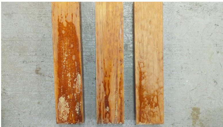
Fotografía 14 Ejemplo del tipo de tratamiento que tuvo la madera dentro de la autoclave que se utilizó para la fabricación de las bancas de la avenida Masaryk.
