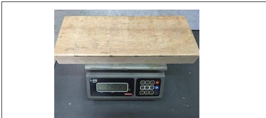
Fotografía 4 Ejemplo de cómo se pesa la madera en la báscula para así al final del tratamiento sacar el diferencial del peso que absorbió la madera de resina.
