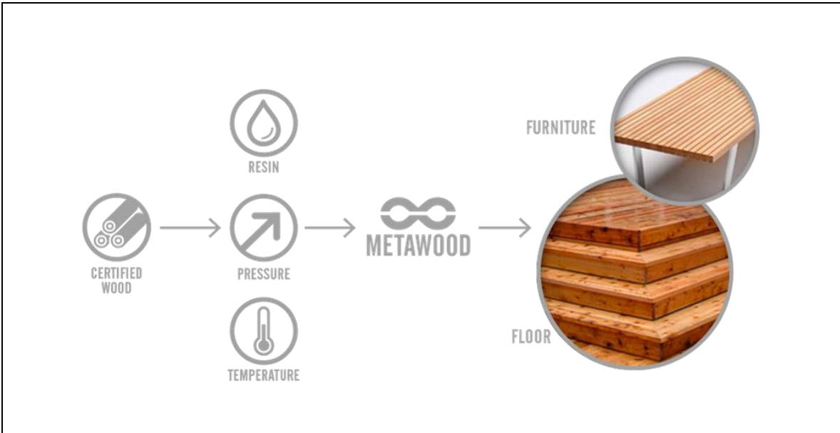
Imagen 6: Imagen final de elección del tratamiento de la madera de pino, con los parámetros del tratamiento dentro de la autoclave.
