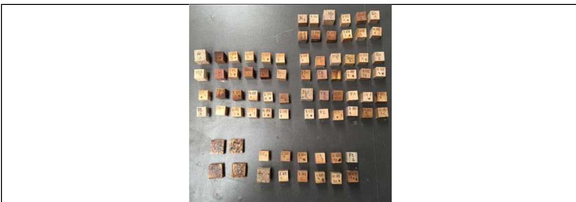
Fotografía 9: Total de probetas de distintos tipo de maderas analizadas para el experimento de temperatura
