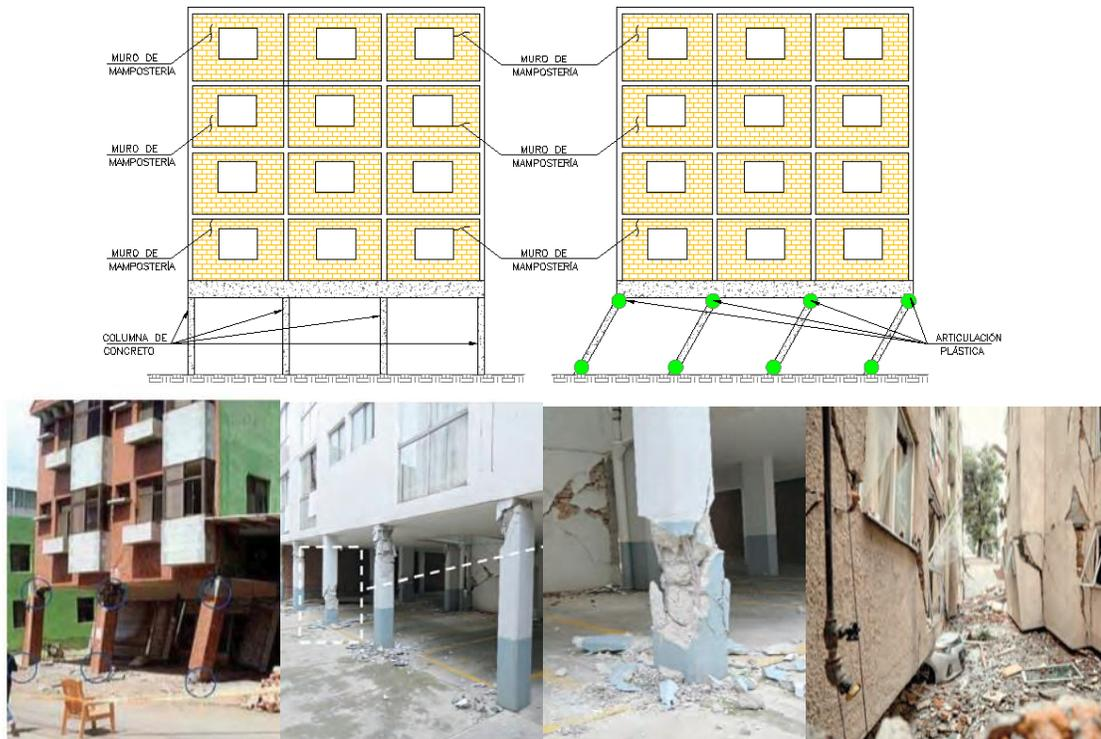
**Figura 5.1.** Comportamiento de la *planta baja débil*, conceptual y real.
