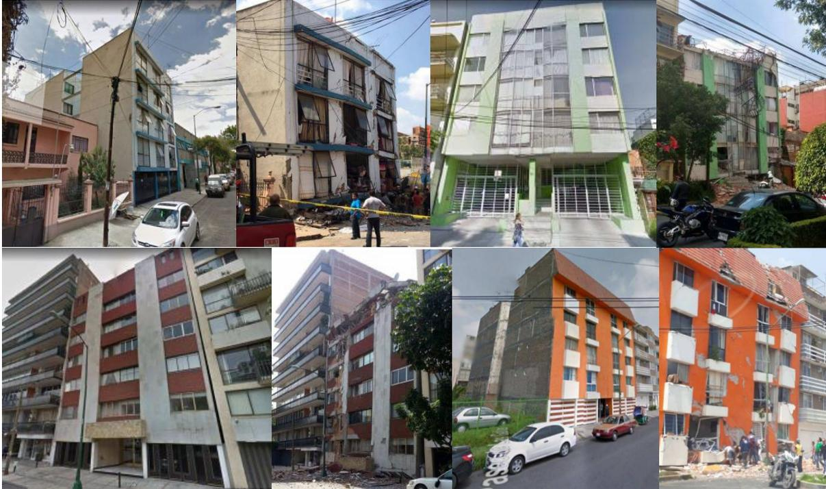
Figura 1.2. Estructuras colapsadas por *planta baja débil* en el sismo de 2017. (Google maps)
