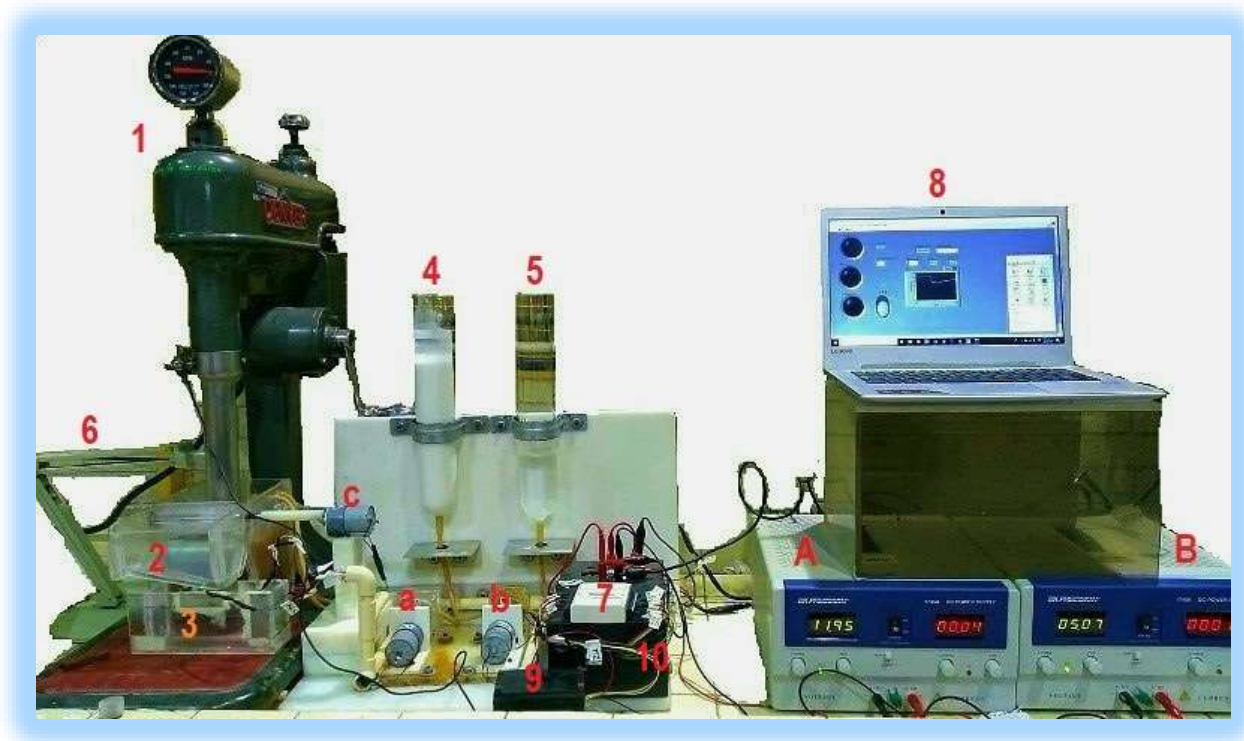
Figura II.3 Celda de flotación con control semiautomático.
