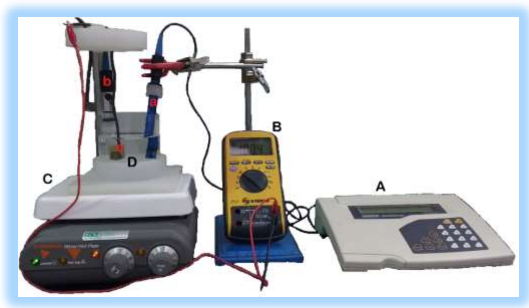
Figura II.2 Equipo montado para medidas de potencial de reposo.
