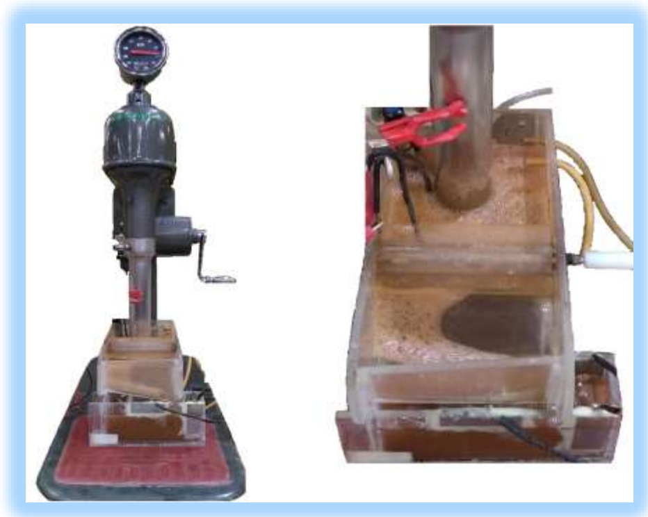
Figura II.5 Extracción del concentrado en celda Denver Lab 12
