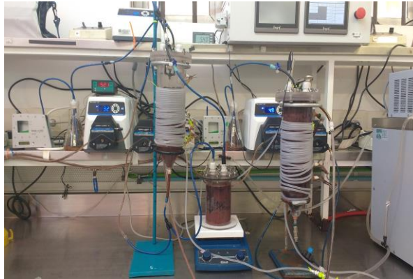
Figura 14. Reactores de biomasa fija, izquierda TBR y derecha reactor UASB.
