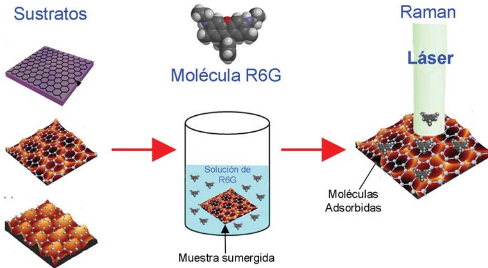
Figura 5.17 Ilustración esquemática del proceso experimental para estudiar el efecto SERS y GERS en diferentes sustratos: nanoconcauidades y nanodomo de Al, así como en sustratos usados como referencias.
