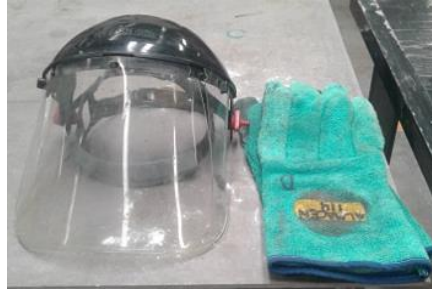
Figura 19. Equipo de protección utilizado durante el tratamiento térmico.
