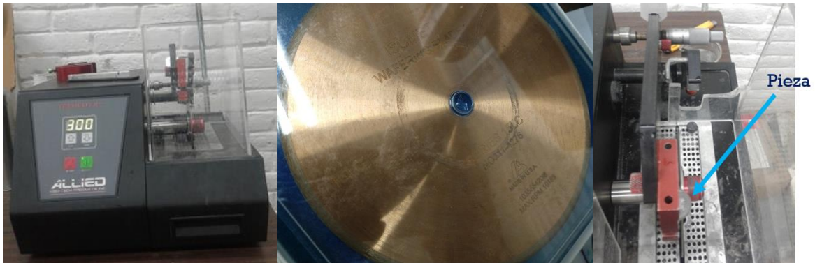
Figura 15. Cortadora ALLIED y disco de diamante ISOMET 11-4276 a 300 rpm.
