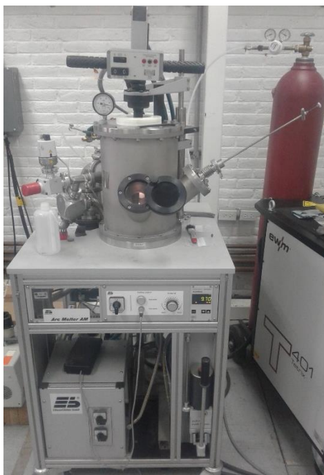
Figura 14. Horno de arco eléctrico Arc Melting Sistem AM Edmund Bühler GmbH.
