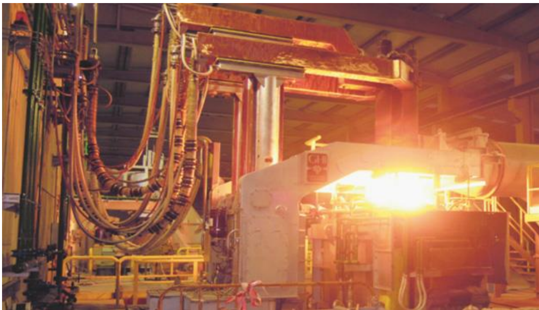
Figura 5. Horno de arco eléctrico de nivel industrial. Obtenida de: gih SMART FURNACES.
