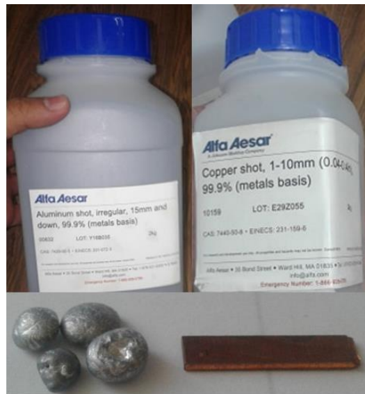
Figura 13. Materia prima ocupada para la elaboración de las aleaciones. Aluminio (izq.) y cobre (der.).
