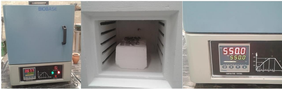
Figura 17. Realización de la sobresaturación de la solución sólida a 550°C durante 5 horas.
