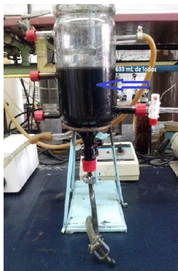
Fig. 3.2. RALLFA a escala de laboratorio instalado (Poblete-Mier, 2015)
