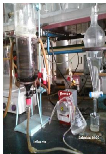
Fig. 3.3. Sistema completo del RALLFA (Poblete-Mier, 2015)
