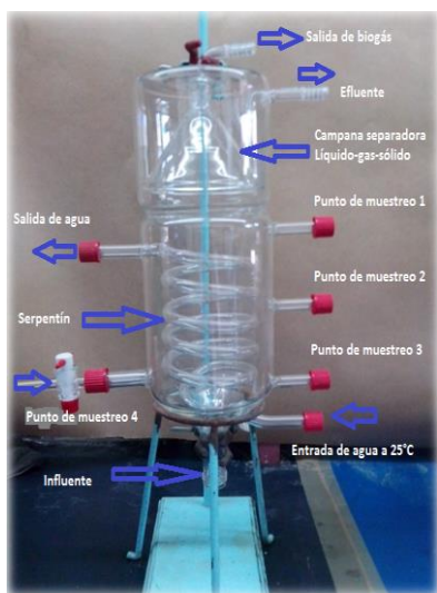
Fig. 3.1. Reactor tipo RALLFA (Poblete-Mier, 2015)
