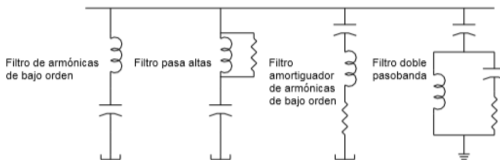
Figura 3.18. Conexiones típicas de un reactor filtro.
