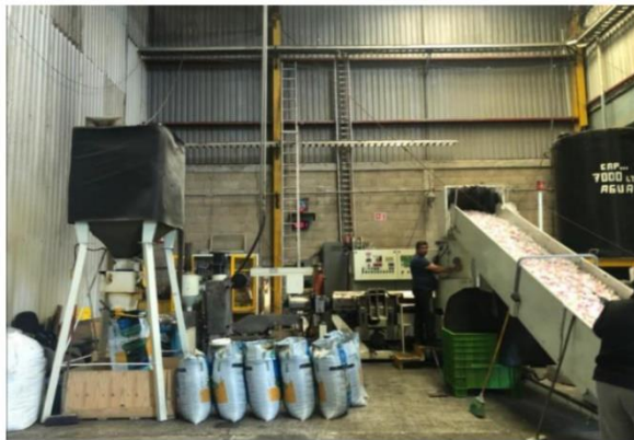
Figura 5.33 Identificación y pelletizado de PET. DIBASA S.A. DE C.V. Fuente: Chávez Jazmín et al. (2019).
