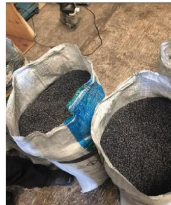
Figura 5.33 Identificación y pelletizado de PET. DIBASA S.A. DE C.V. Fuente: Chávez Jazmín et al. (2019).
