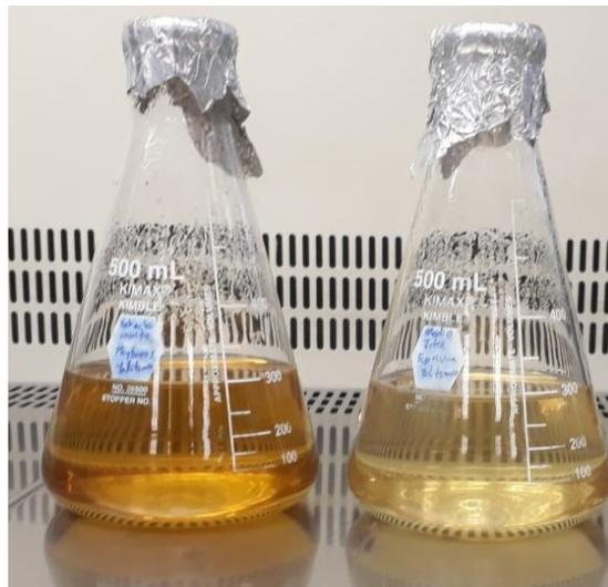
**Figura 8. SDA (sabouraud-dextrosa-agar) y PDA (papa-dextrosa-agar) con antibiótico.**
