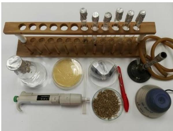
**Figura 9. Materiales empleados para la dilución en serie.**
